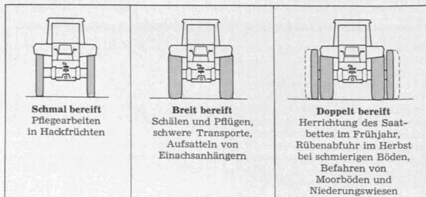
Abb. 70 Einfluß der Pflanzenkultur auf die Reifenbreite des Schleppers
