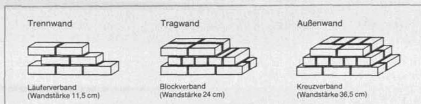
Abb. 88 Mauerverbände (Normalsteine) unterschiedlicher Funktion
