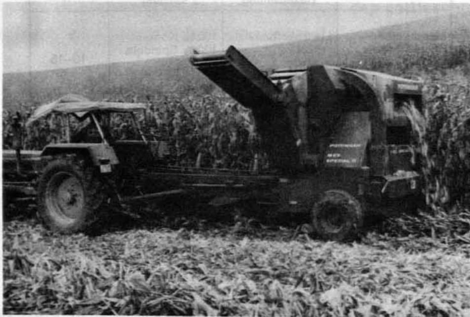
Abb. 3: Spezialmaschine für die Ernte von geschroteten und ungeschroteten Maiskolben
