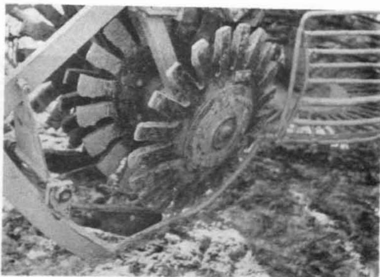
Bild 34 Rodehubrad zur Verringerung des Erdbesatzes (Werkfoto)
