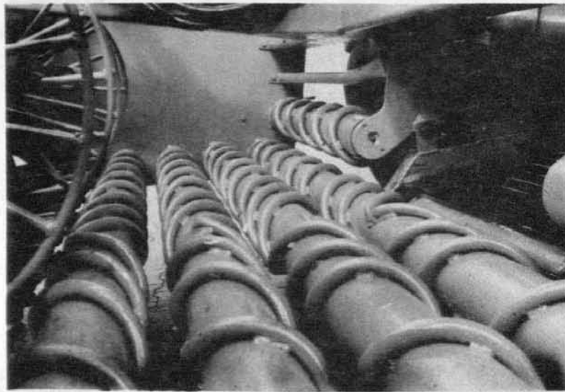
Bild 33 Neuartige Reinigungsorgane in Zuckerrüben- erntemaschinen (Werkfoto)
