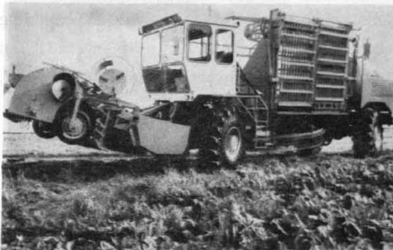
Bild 42 Selbstfahrender sechsreihiger Köpfrodebunker beim Wenden (KRB)
