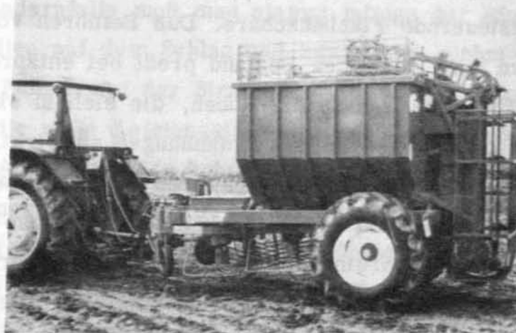
Bild 47 oben: Vom Schlepper geschobener und gezogener Köpfrodelader (KRL + T) Mitte: Der Schlepper schiebt in Rückwärtsfahrt den Köpfroder (KR). Die Rüben liegen im Längsschwad zwischen den Schlepperreifen unten: Der Rübenlängsschwad wird durch einen nachfolgenden Ladebunker (LB) aufgenommen
