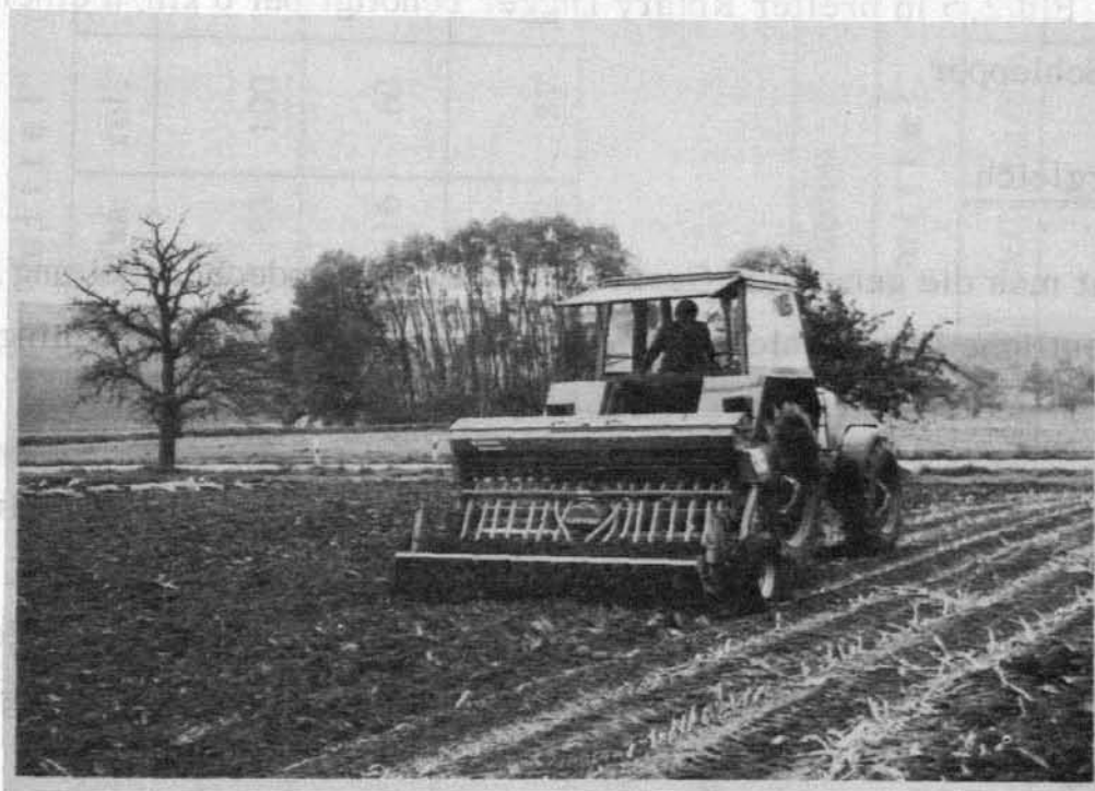
Bild 12: Sind keine tiefen Fahrspuren vorhanden, kann Wintergetreide in einer Überfahrt mit Frässaatmaschinen bestellt werden.
