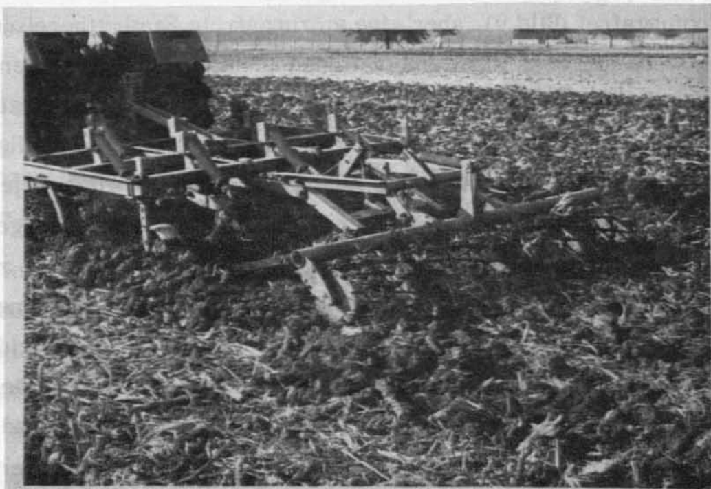
Bild 9: Gehäckseltes Maisstroh läßt sich zwar verstopfungsfrei mit dem Grubber einarbeiten, aber eine störungsfreie Saatbettbereitung ist nur mit zapfwellengetriebenen Geräten möglich
