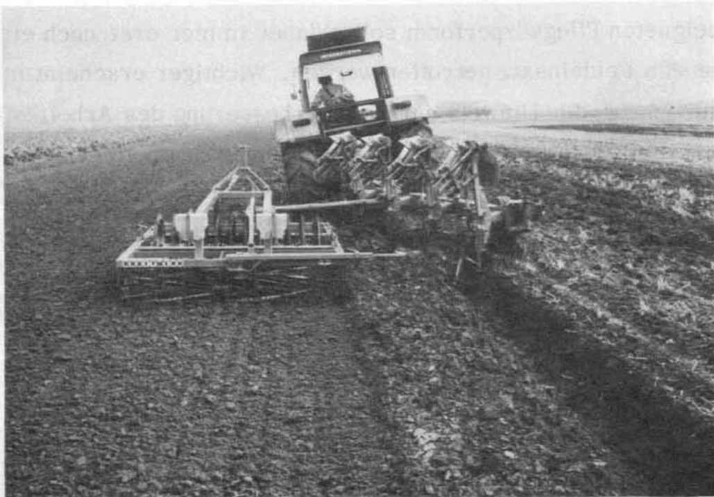
Bild 7: Mitgeführte Packerkombinationen verringern den Aufwand für die Saatbettbereitung nach dem Pflügen.
