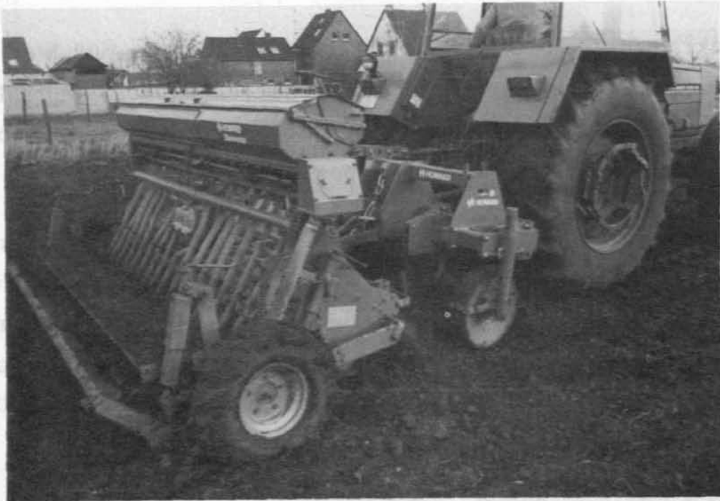
Bild 11: Zweibalkige Grubber kombiniert mit zapfwellenge- triebenen Geräten und Sämaschinen ermöglichen eine Bodenlockerung und Bestellung in einem Arbeitsgang.
