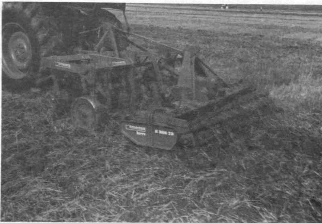
Bild 4: Mit Grubbern kombinierte zapfwellengetriebene Geräte sind vielseitig verwendbar, aber zur Stroheinarbeitung nur auf schweren Böden erforderlich.
