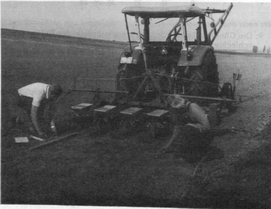
Abb. 10a: Eine Kontrolle der Saatablage durch Nachmessen der Ablagetiefe und -weite ist sehr ratsam (Foto Verfasser)
