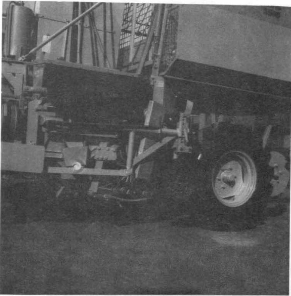
Abb. 16: Längsputzer, seitenbewegliches Polder- oder Rüttelschar und angetriebener Seitenstern kennzeichnen heute die Putz- und Rodegruppe einer modernen einreihigen Köpfrödebunkermaschine
