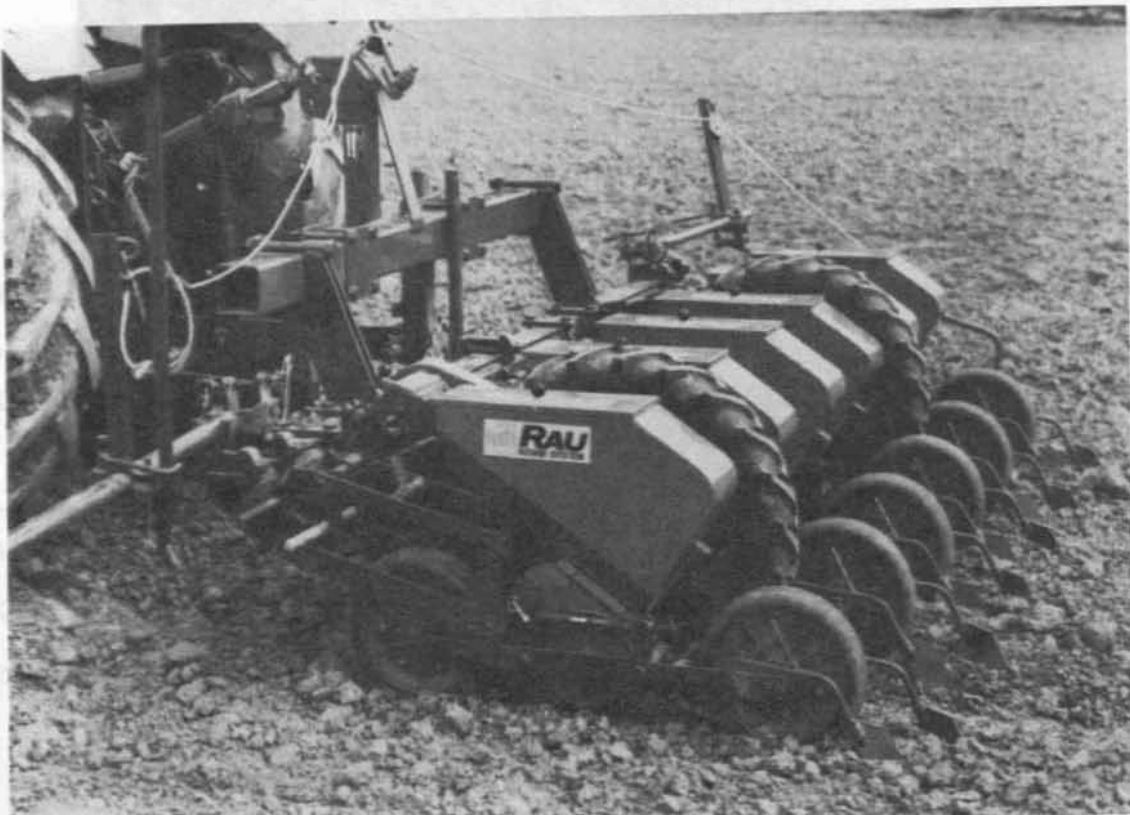
Abb. 2: Tröster (Rau) Exakta S, Beispiel einer mechanisch mit Zellenrad (Außenbefüllung) arbeitenden Einzelkornsämaschine für die Rübenausaat (DLG-anerkannt, Berichts-Nr. 2651) - Firmenfoto -
