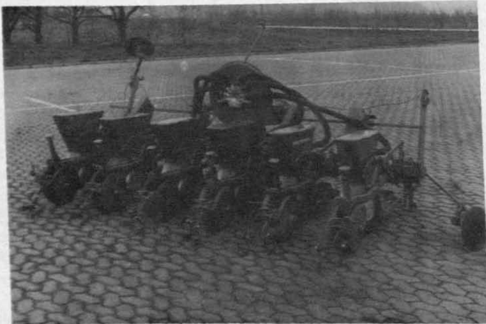
Abb. 4: Nodet Pneumasem II, Beispiel einer pneumatisch mit Saugluft und Lochscheibe arbeitender Einzelkornsämaschine (DLG-angemerkt für die Rübenausaat, Berichts-Nr. 2756); Umrüstung auf Mais und andere Samen ist möglich. - Firmenfoto -
