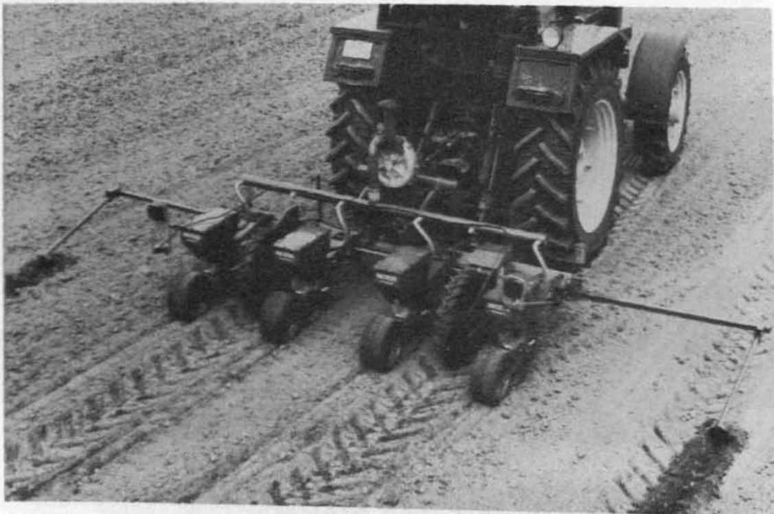
Abb. 5a: Becker Aeromat II, ausgerüstet zur Maisaussaat, 4-reihig (DLG-anerkannt, Berichts-Nr. 2943) - Firmenfoto
