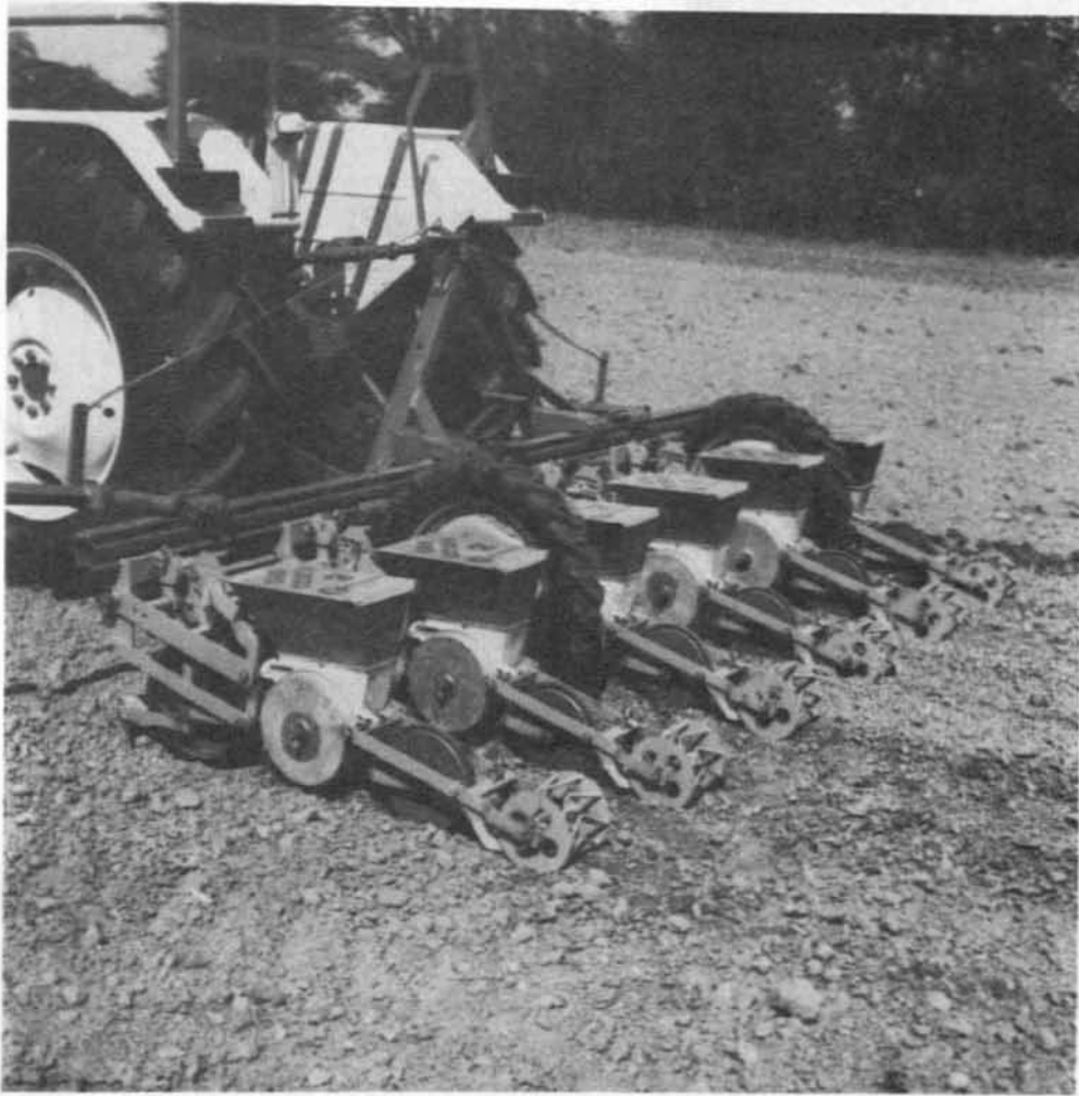
Abb. 3: Kleine Unicorn 2, Beispiel einer mechanisch mit Zellenrad (Innenbefüllung) arbeitenden Einzelkornsämaschine für die Rübenpillenaussaat (DLG-anerkannt, Berichts-Nr. 2864) - Firmenfoto -
