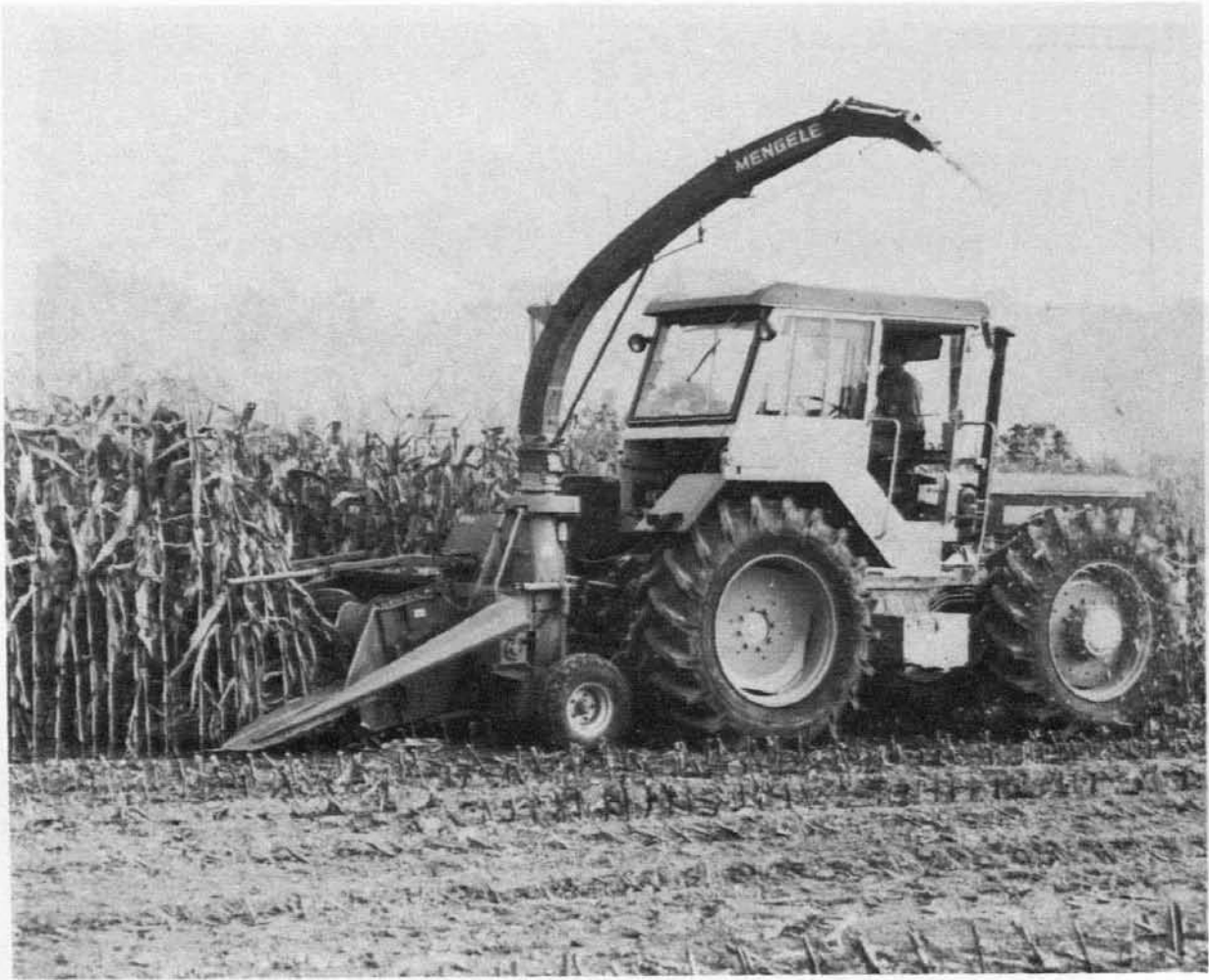
Bild 5: Beispiel für neue Einsatzmöglichkeiten: Dauerrückfahrt (Schubfahrt) beim Großflächen-Maishäckseln, attraktiv durch relativ niedrige Investitionskosten. Erhöhte Anforderungen an die Rückwärtsstufung des Getriebes.
