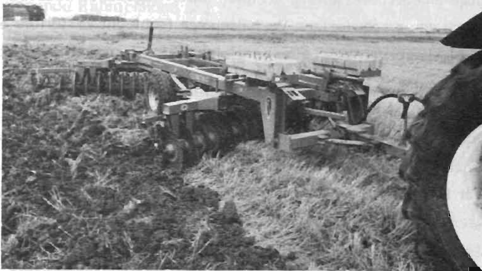
Bild 1: Eine gleichmäßige Strohverteilung im Boden lässt sich in einer Überfahrt mit schweren Scheibeneggen.....
