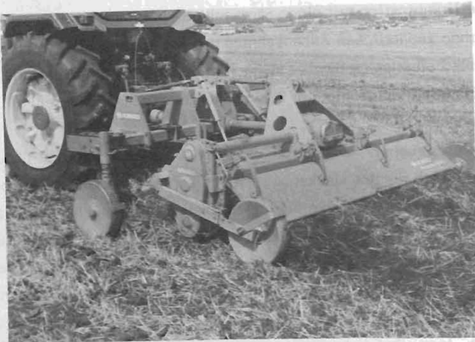
Bild 4: Eine gleichmäßige Strohverteilung im Boden läßt sich in einer Überfahrt mit Grubbern in Kombination mit zapfwellengetriebenen Nachlaufgeräten erreichen.
