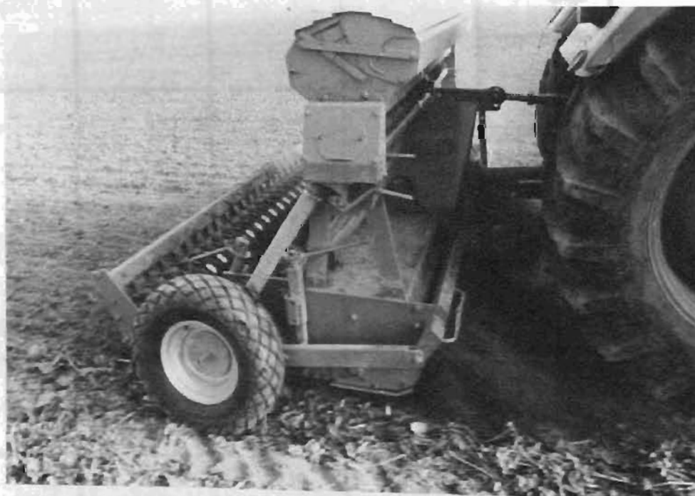
Bild 23: Die größte Schlagkraft wird erreicht, wenn auf eine tiefere Bodenlockerung verzichtet wird. Der Einsatz von Frässaatmaschinen hat sich hierzu bewährt.
