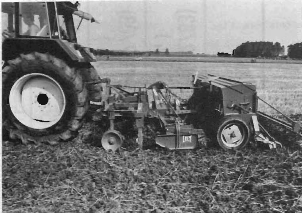
Bild 22: Kurz gebaute Grubberkombinationen mit angebauter Sämaschine erledigen Grundbodenbearbeitung, Saatbettbereitung und Saat in einer Überfahrt.
