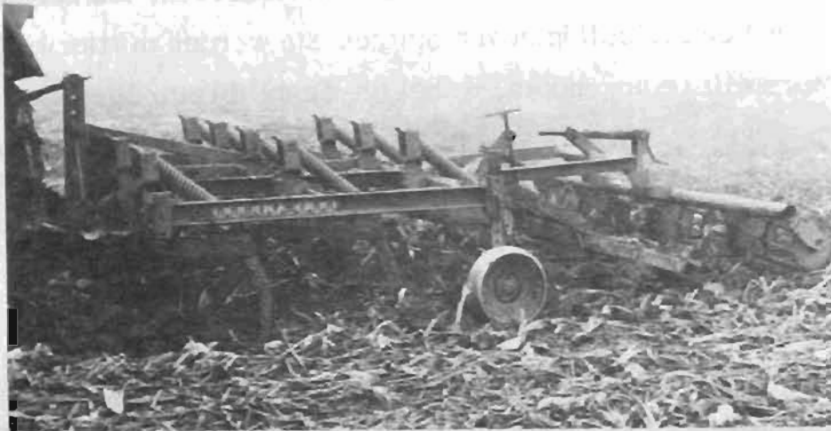
Bild 8: Mit herkömmlichen Grubbern kann bei der Grundbodenbearbeitung nicht tiefer als 20 - 25 cm gelockert werden.
