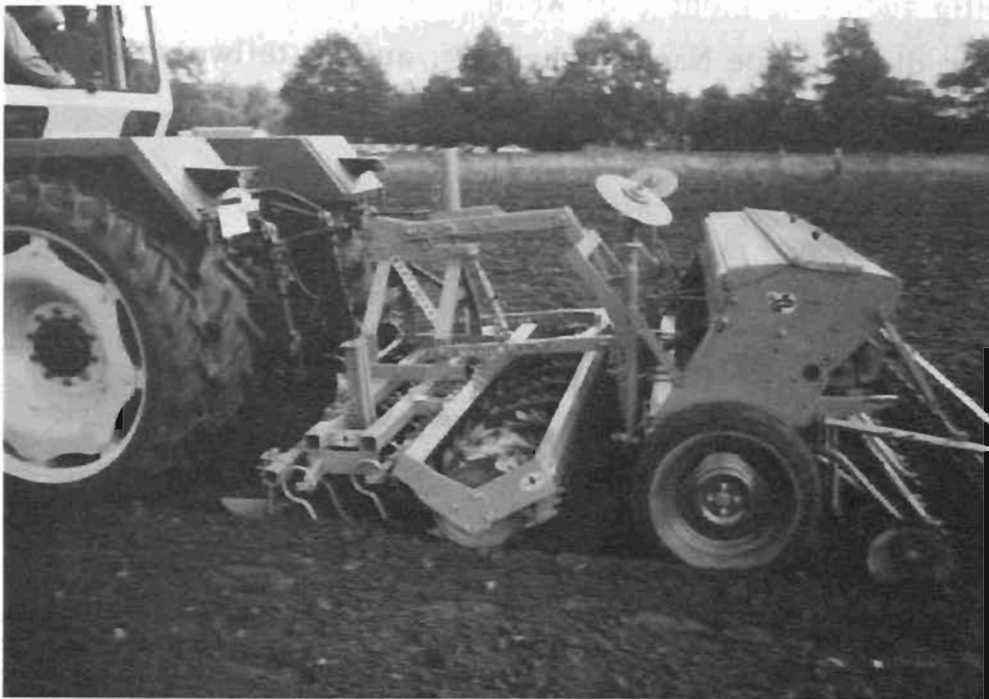
Bild 12: Kurz gebaute Kompakteggen, kombiniert mit einer Sämaschine sind auf leichten Böden eine kostengünstige Alternative zu zapfwellengetriebenen Bestellkombinationen.
