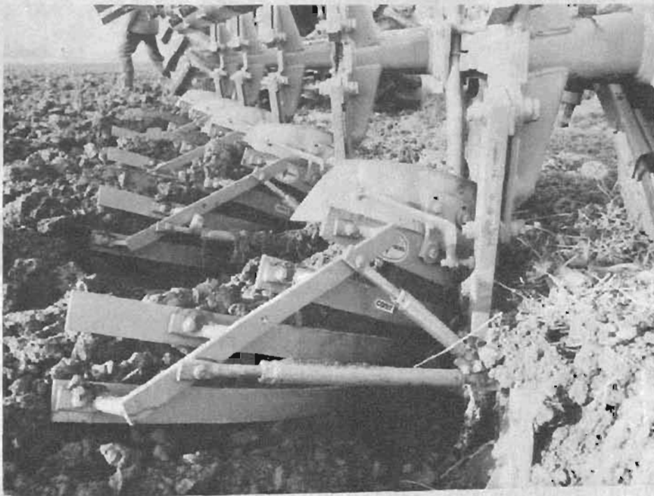
Bild 6: Pflüge mit Streifenkörpern sind eine bevorzugte Alternative für "klebende" Böden oder für Standorte mit stark wechselnden Bodenverhältnissen.
