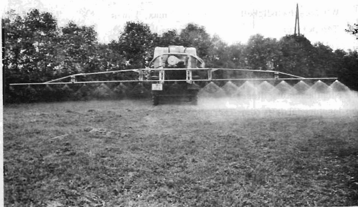
Bild 1: Beim Spritzen mit nur 1,5 - 2,5 bar sind die Tropfen größer (links) und die Abdriftgefahr geringer als bei Betriebsdrücken über 4,5 bar (rechts).
