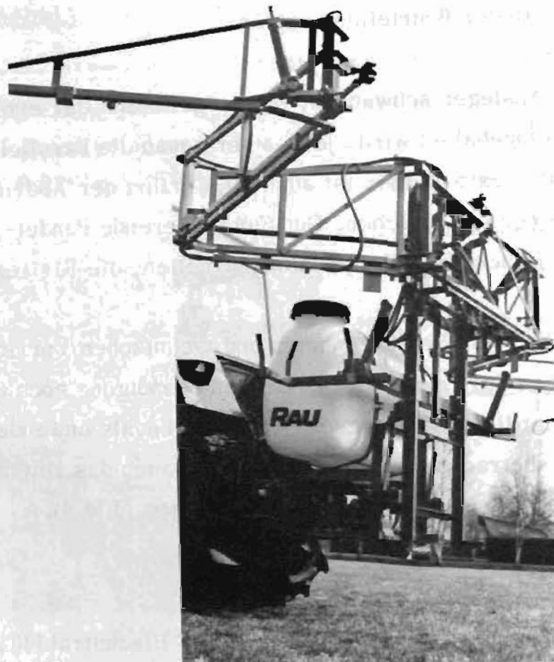
Bild 3: Hydraulisch klappbares Spritzgestänge mit Pendleinrichtung und automatischem, mechanischem Hangausgleich.
