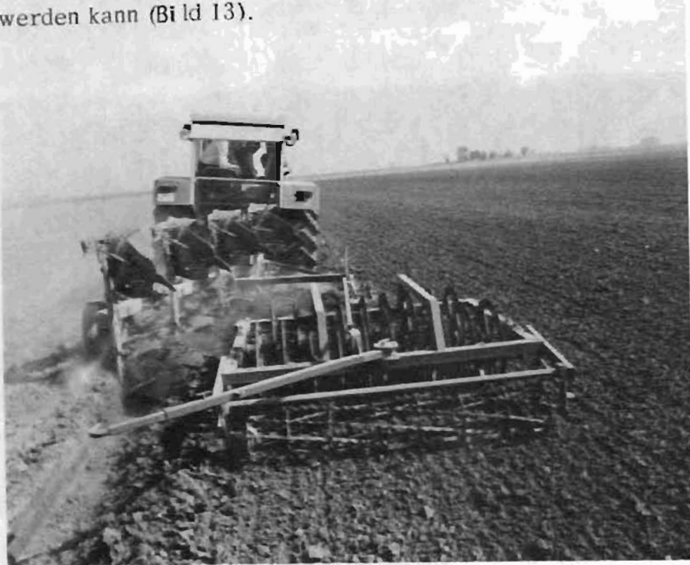
Bild 13: Beim Pflügen mitgeführte Packerkombinationen hinterlassen auf leichten Böden einen saarfertigen Acker.
