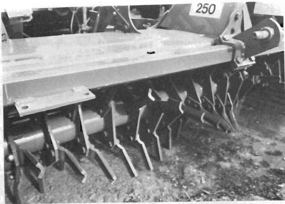
Bild 17: Zinkenrotoren zur Saatbettbereitung auf schweren Böden gewinnen zunehmendes Interesse.
