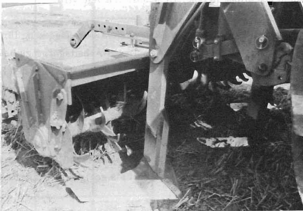
Bild 20: ..... empfiehlt sich die Verwendung von Geräten mit nicht wendenden und mischenden Lockerungswerkzeugen.
