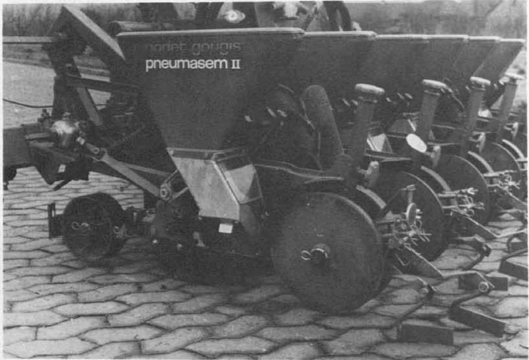
Abb. 10: Einzelkornsämaschine Nodet Gougis PNEUMASEM II in Ausrüstung für Rübenaussaat, tandemgeführt, pneumatisch mit Saugluft befüllte Lochscheibe, Kardanwellenantrieb (DLG-Bild)
