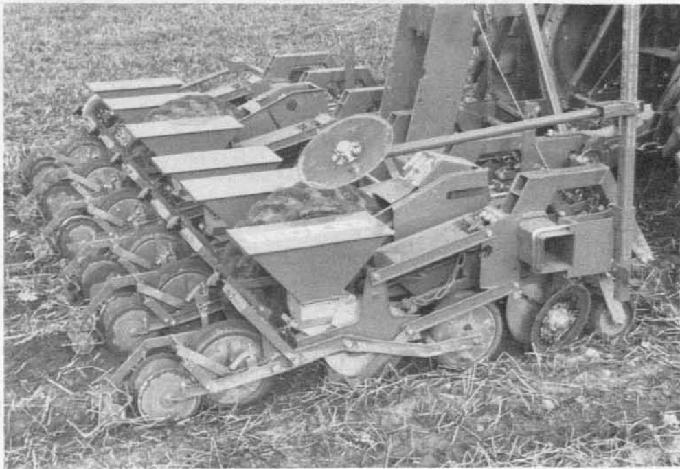
Abb. 16: Becker Einzelkornsämaschine CENTRA-Super CS-RS mit Räumscheiben-Mulchsaatausrüstung (Werkbild Firma Becker)
