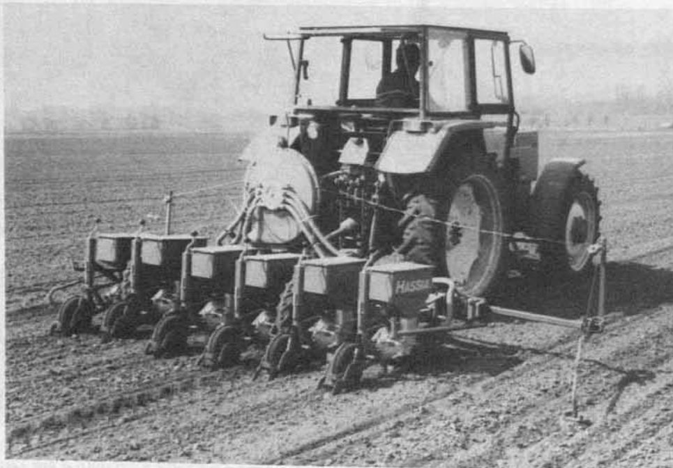
Abb. 11: Einzelkornsämaschine Tröster UNISEM UNR in Ausrüstung für Rübenaussaat, tandemgeführt, pneumatisch mit Saugluft befüllte Lochscheibe (Werkbild Firma Tröster)
