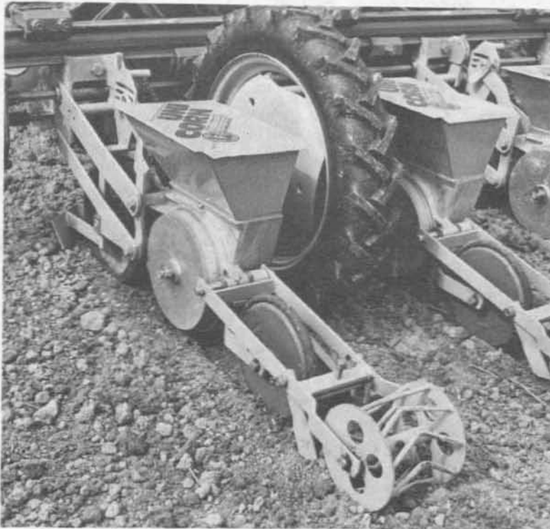
Abb. 5: Einzelkornsämaschine Kleine UNICORN-2, stützradgeführt, innenbefülltes Zellenrad (Werkbild Firma Kleine)
