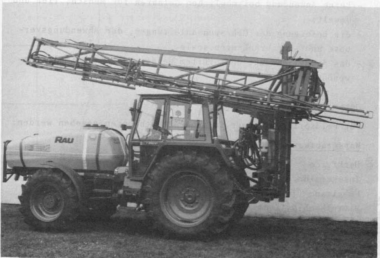
Bild 2: Aufbauspritze für Fendt-Geräteträger mit 1600 l Behälter, elektronischer Dosierregelung, elektrischer Fernbedienung, hydraulisch klappbarem 24 m Gestänge und 140 l Spülwasserbehälter. Für den Aufbau und den Abbau braucht keine Schlauchverbindung gelöst zu werden (Werkfoto Rau)
