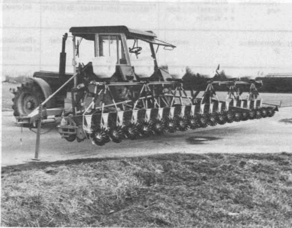
Abb. 1: Aufgebauter Mikrogranulatstreuer, eine Zusatzausrüstung zur Einzelkornsämaschine (Werkbild Firma Kleine)
