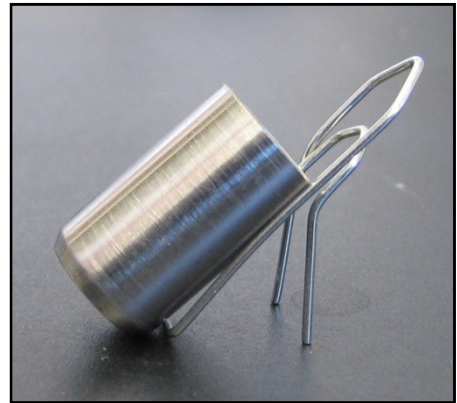
Abbildung 41: Stechkappe aus Chrom-Molybdän-Stahl
