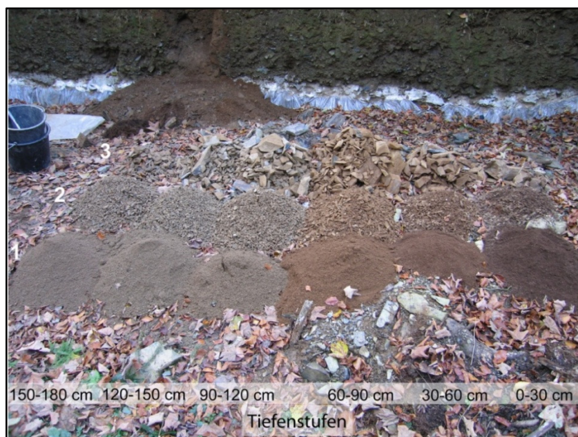
Abbildung 40: Ausgesiebte Skelettfractionen - Feingrus (1), Mittelgrus (2), Grobskelett (3) - der beprobten Tiefenstufen am Beispiel des Bodenprofils P9
