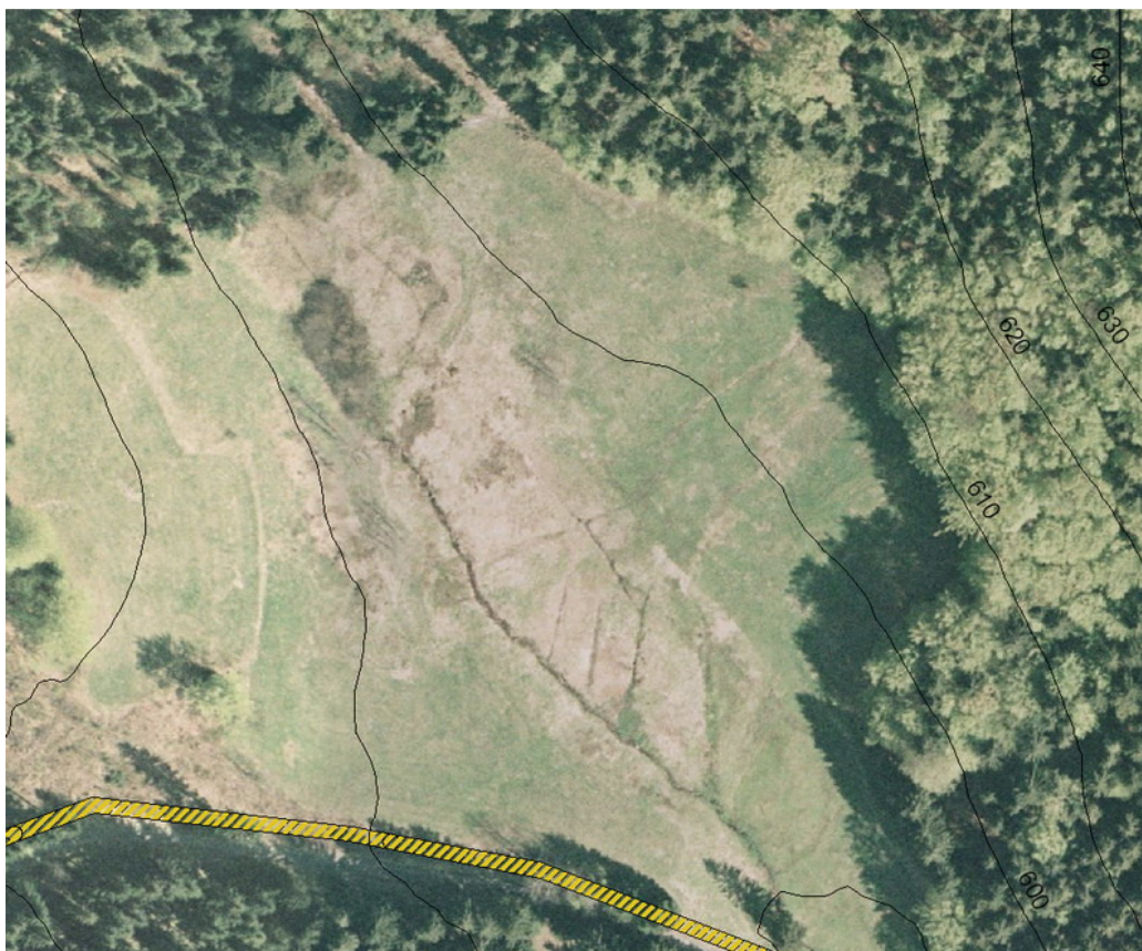
Abbildung 49: Bestockungslose Fläche mit deutlich sichtbaren Strukturen, die auf oberflächlich abfließendes Wasser infolge gesättigter Flächen hindeuten.
