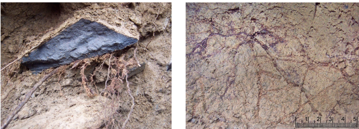
Abbildung 76: Wurzeln innerhalb des Staukörpers unter einem Buchen-Bergahorn-Mischbestand und das dadurch entstandene Sekundärporensystem im rechten Bild (Tiefe: 1,50 m, L_{d,eff} = 1,58 \text{ g/cm}^3 , schluffiger Sand)
