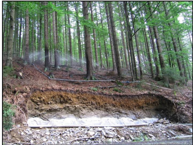
Abbildung 38: Fertiges Bodenprofil mit laufender Beregnungsanlage im Hintergrund
