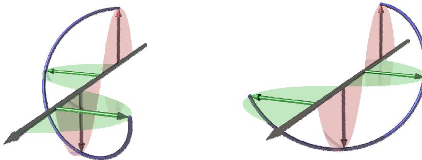
Abbildung III-3: Zirkular polarisiertes Licht im Wellenbild, links: links zirkular polarisiertes Licht, rechts: rechts zirkular polarisiertes Licht
