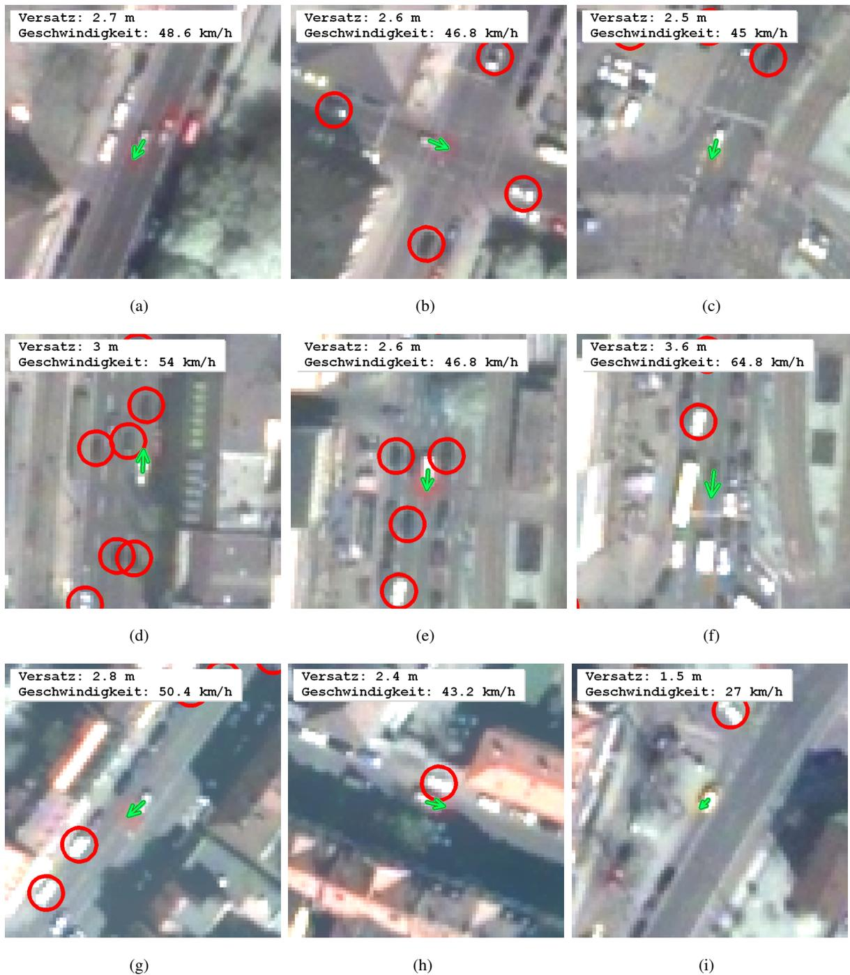
Abbildung 6.8: Ergebnisse der Bewegungsschätzung. Der grüne Pfeil verläuft von der Fahrzeugposition im panchromatischen Kanal zur Position in den multispektralen Bändern. Die Länge des Pfeils ist proportional zur Geschwindigkeit. Isolierte Fahrzeuge ohne ermittelten Versatz sind durch rote Kreise gekennzeichnet.
