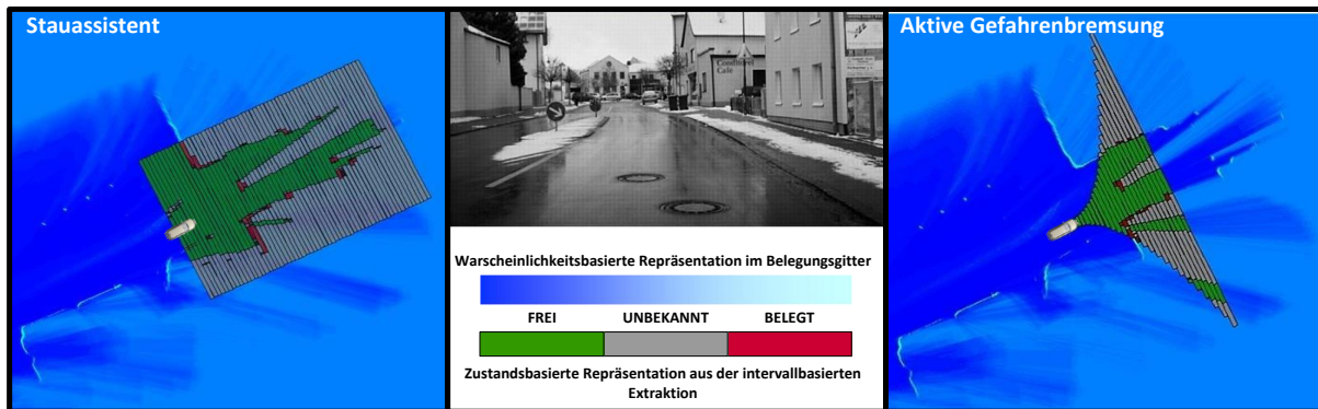
Abbildung 7.7: Intervallbasierte Belegungsextraktion für den Stauassistent und für die Aktive Gefahrenbremsung in der gleichen Szene
