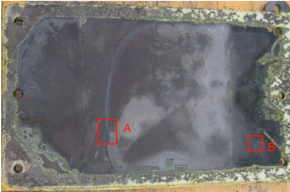
Abbildung 4.29: Crofer 22 APU Stack: Anode nach dem Test. Die Rechtecke zeigen die Stellen aus denen Proben für die REM/EDX-Analysen gefräst wurden: A: In Strömungsrichtung vor dem Nickelnetz; B: nach dem Nickelnetz.
