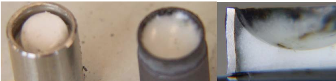
Abbildung 4.21: Bestimmung des Glasmelzpunktes (I): Links eine bei 850^\circ\text{C} gesinterte Probe (I), in der Mitte eine bei 1100^\circ\text{C} gesinterte Probe (II). Rechts ein Schnitt durch Probe (II).
