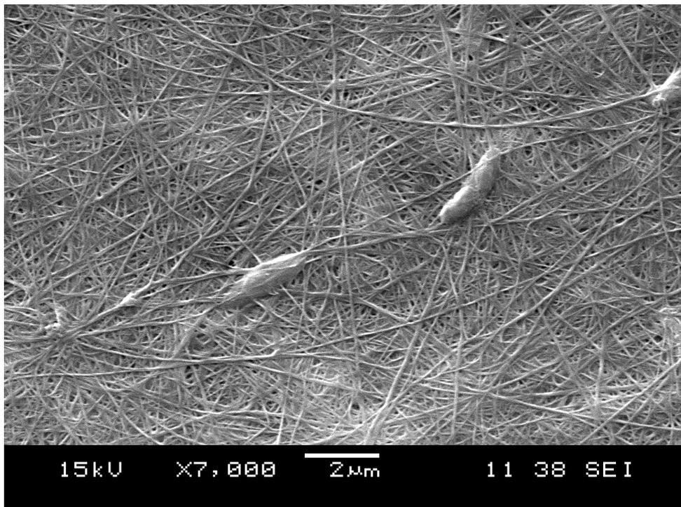
Abbildung 85: Oberfläche eines gefriergetrockneten Pellikels bei 7000 facher Vergrößerung (REM). Zellen von *Gluconacetobacter xylinus* stellen ein dichtes Netzwerk aus Cellulosefasern her.
