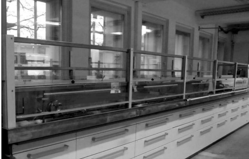
Abbildung 16: "Horizontal Lift Reactor"(Holir) [Kralisch *et al.*, 2010]. Cellulosepellikel werden kontinuierlich mit einem Förderband aus einem langgestreckten Glastank gefördert
