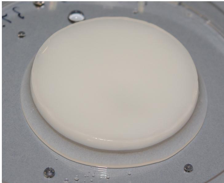
Abbildung 64: Auf der Membranoberfläche produzierter Pellikel mit einer Höhe von 5 mm und einem Durchmesser von 45 mm.
