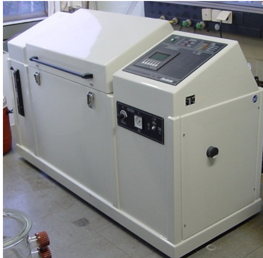
Abbildung 5.9 Salzsprühnebelkammer zur Korrosionsprüfung nach DIN 50021
