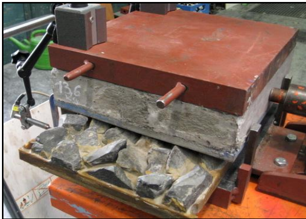
Abb. 2.10: Bestimmung der horizontalen Steifigkeit, der Gleit- und Haftreibung der Besohlung auf der TUM-Platte
