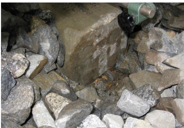
Bild 11: Ermittlung des QVW nach Simulation eines Regefalls im Labor des Prüfamtes für Verkehrswegebau.
