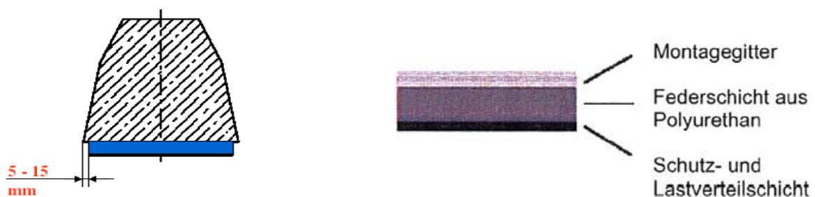
Abb. 2.2: QS einer besohnten Schwelle (links). Möglicher Aufbau einer Schwellenbesohlung (rechts).
