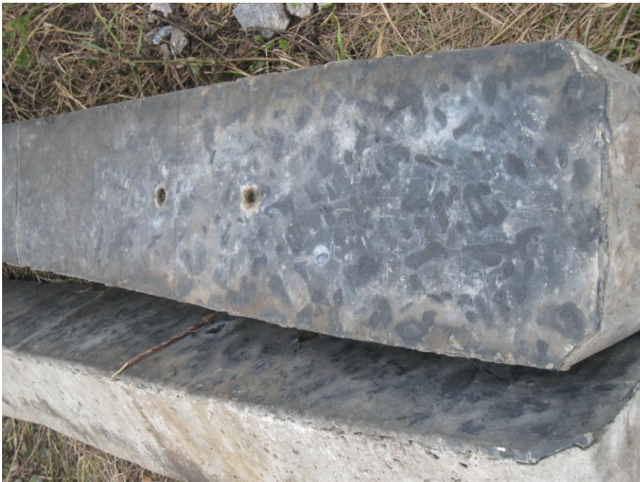
Bild 4: Spreepolymer mit C = 0,3 \text{ N/mm}^3 nach 160 Mio. Lt Betriebsbelastung, Quelle: [34].
