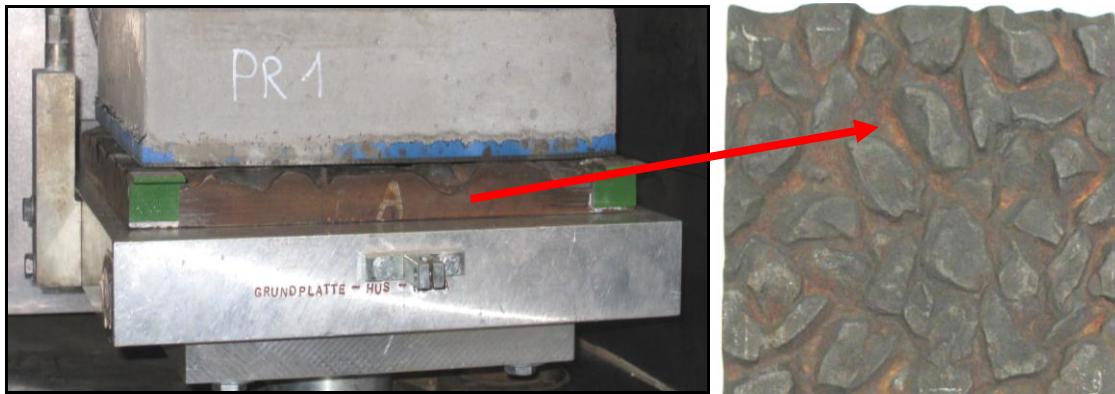
Abb. 2.3: Prüfung nach DBS 918 145-01 auf NSP
