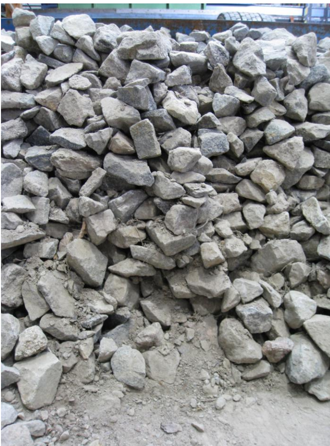
Bild 6: Tiefenschnitt von Schotter Typ A nach 3,5 Mio. Lw im Oberbau mit unbesohlenen Schwellen: Der harte Kontakt zwischen den Schotterkörnern und der Betonsohle sowie die steifen Untergrundverhältnisse (Betonboden) verursachten die Schotterschädigung unter der Schwelle. Feinpartikel und Abriebstaub wanderten nach unten.
