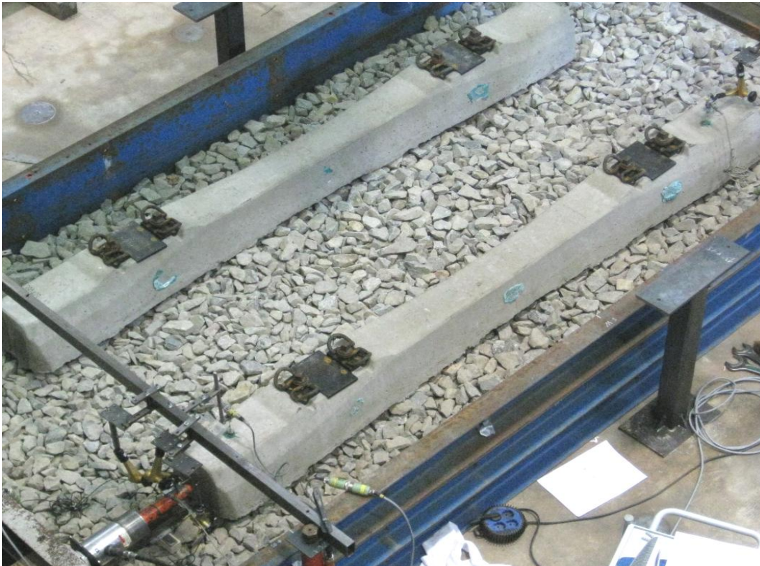
Bild 14: Versuchsaufbau zur Bestimmung des primären Sohlwiderstands bei Besohnten und konventionellen Schwellen
