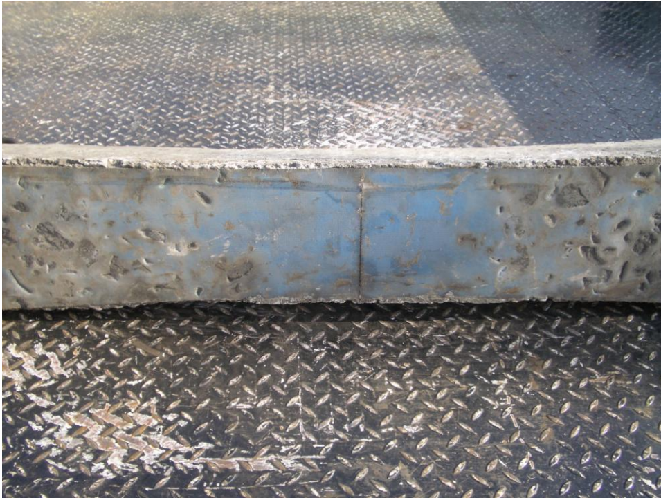
Bild 3: SLB 2210 G mit C = 0,22 \text{ N/mm}^3 nach 190 Mio. Lt Betriebsbelastung, Quelle: [34].
