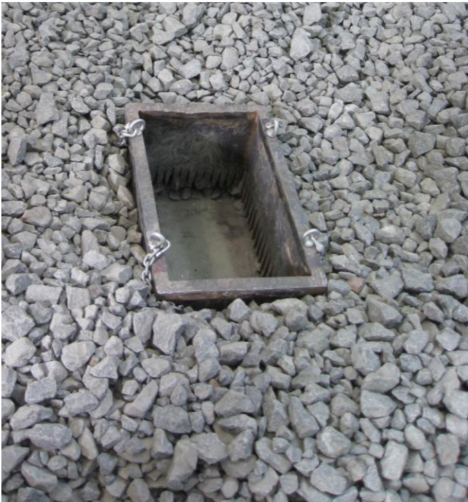
Bild 5: Entnahme von Schotterproben im Neuzustand unter definierten Bedingungen durch Anwendung der Kastenmethode.
