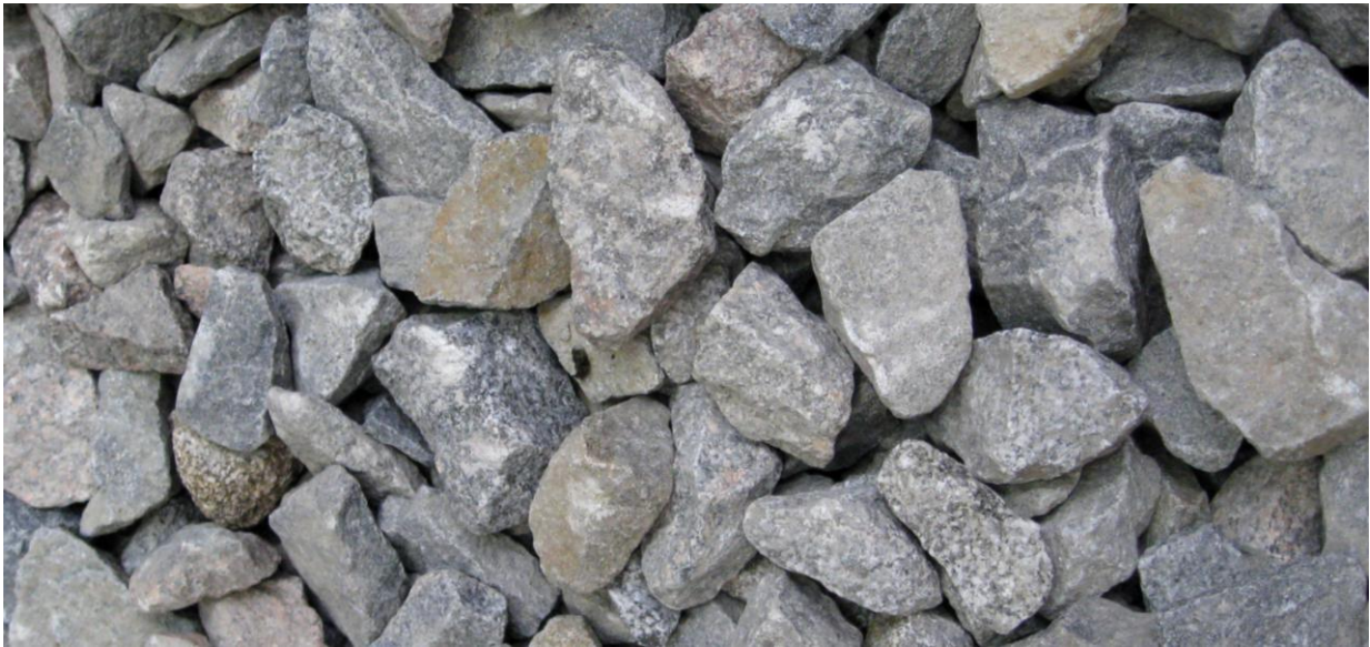
Bild 7: Schotter Typ A nach 3,5 Mio. Lw: Die Kontaktfläche zwischen der unbesohnten Betonschwelle und dem darunter liegenden Schotter betrug nur 2 % – 3 %, wodurch sich hohe Druckspannungen bildeten. Dies führte zur Zermalmung und starkem Abrieb im Bereich der Kanten und Spitzen der einzelnen Körner (durch weiße Flecken ersichtlich).
