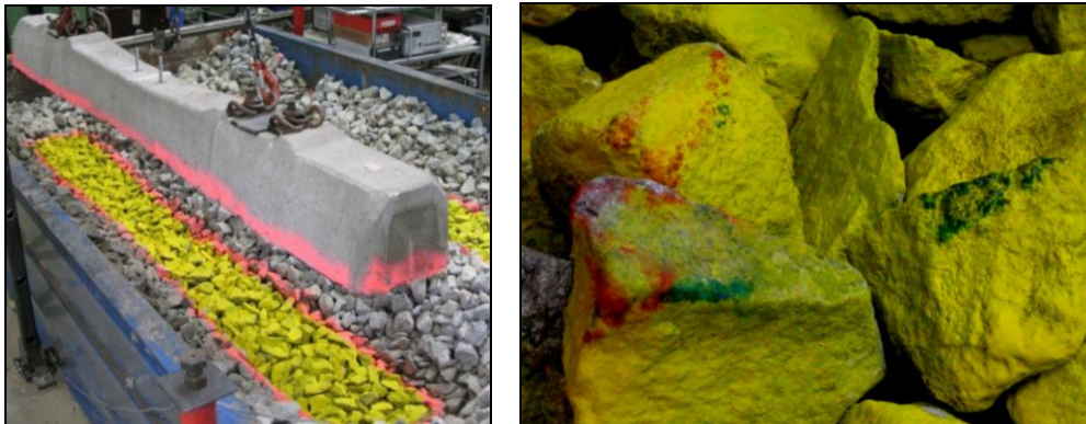
Abb. 3.7: Herausnahme der Schwelle vom Schotterbett (links); Die Schotterabdruckfarben der Sohle markierten auch die Spitzen der obersten Schotterlage (rechts)
