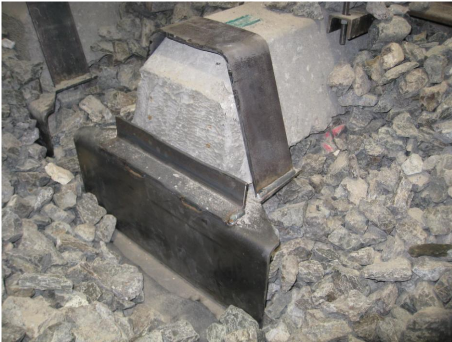
Bild 12: Bestimmung des QVW mit Sicherungskappen (SIK). Die SIK besteht aus einer Stahlplatte mit den Abmessungen 20,5 x 50 cm und wird im Schwellenkopfbereich montiert. Quelle: [42].
