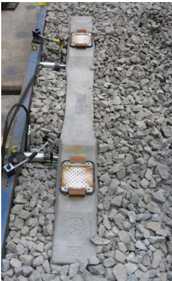
Bild. 17: Versuchsaufbau zur Bestimmung des Längsverschiebewiderstands.
