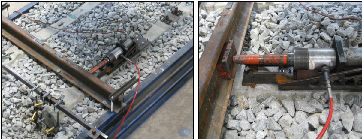
Abb. 4.18: Verfahren des Prüfamtes für Verkehrswegebau zur Messung des QVW im Betriebsgleis, hier im Labor durchgeführt.
