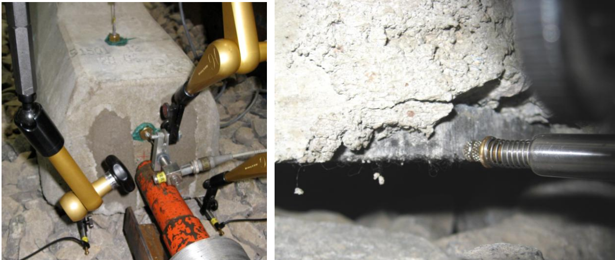
Bild 9: Messung der horizontalen Schwellenverschiebung an der Betonschwelle (links) und an der elastischen Besohlung (rechts).
