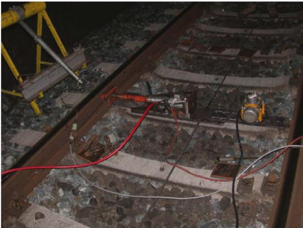
Bild 10: Ermittlung des dynamischen QVW im Gleis. Quelle: [56].
