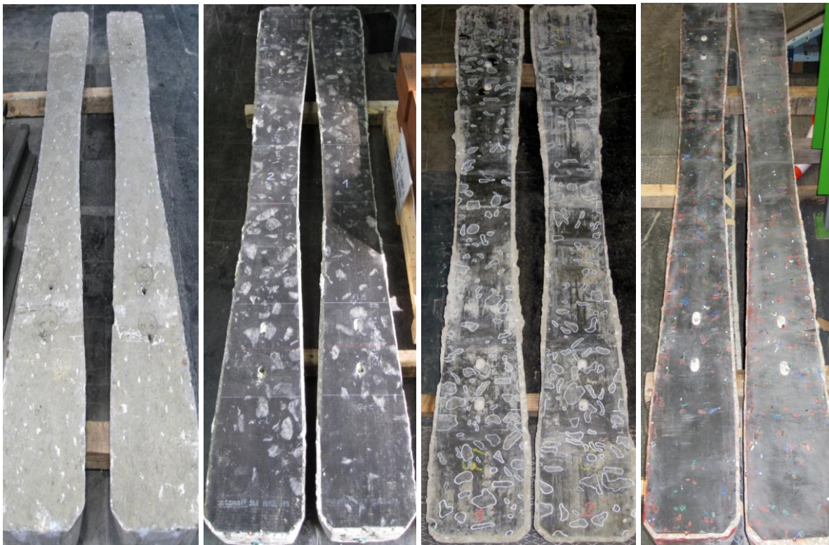
Abb. 3.6: Schwellensohlen nach dem Dauerschwingversuch (Links – konventionelle Schwellen; Mitte links – Schwellen mit Sohle G04 V05; Mitte rechts – Schwellen mit Sohle G04 V03; Rechts – Schwellen mit Sohle Paul Müller).
