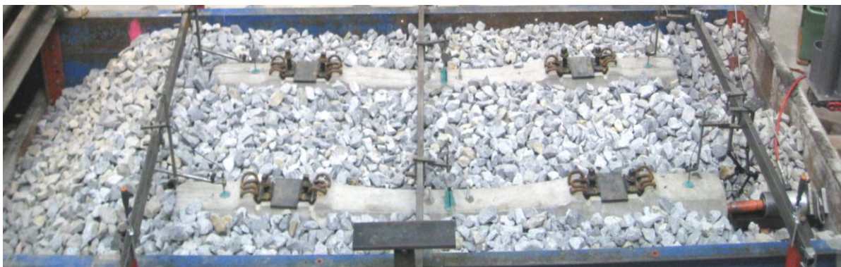
Abb. 4.5: Bestimmung des QVW einzelner Schwellen im Labor
