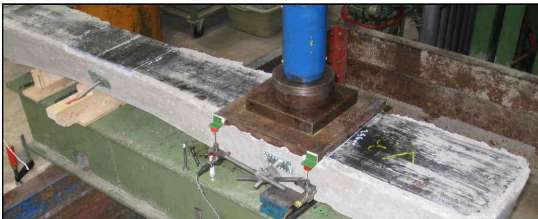
Abb. 2.4: Bestimmung des Bettungsmoduls der Sohle an der Schwellenunterseite. Die Vorpressung wurde mit Hilfe von Stahlelementen aufgebracht
