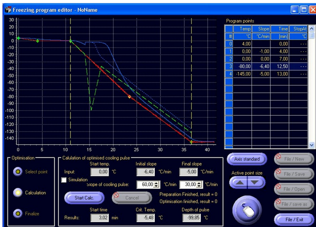
Abbildung 5.2: Kühlprotokoll beim Einfrieren von Gewebeproben: Temperatur (blau) im Inneren der Probe zum Kühlverlauf (rot), s. Tabelle, und optimale Kühlkurve (grün) nach [29] mit zugehöriger Proben temperatur (blau gestrichelt).
