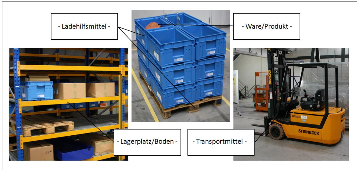
Abbildung 7-5 Kennzeichnungsebenen für den RFID-Einsatz (in Anlehnung an [Gün-09])
