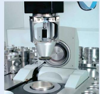
Durch Röntgenfluoreszenzspektroskopie kann qualitativ und quantitativ die Zusammensetzung einer Probe bestimmt werden. Dadurch können Fälschungen von Originalen unterschieden werden, wenn diesen zuvor ein Markierungselement beigemischt wurde.
