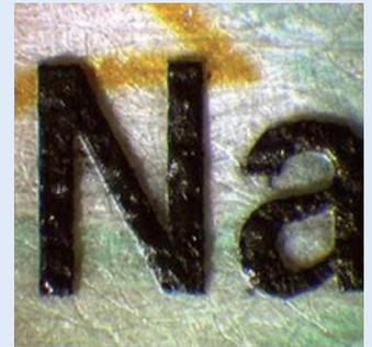
Der Intagliodruck wird auch Stichtiefdruck genannt. Durch spezielle Drucktechniken wird ein fühlbares Oberflächenmuster erzeugt, das bei Streiflicht auch mit dem bloßen Auge sichtbar ist.
