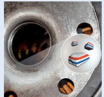
Winzige, sehr widerstandsfähige Kunststoffpartikel, die aus verschiedenen Farbschichten bestehen, erhalten durch eine geeignete Farbzusammensetzung einen einzigartigen Code. Dieser Farbcode ist für das menschliche Auge nicht sichtbar, kann aber mit einem Mikroskop ausgelesen werden.
