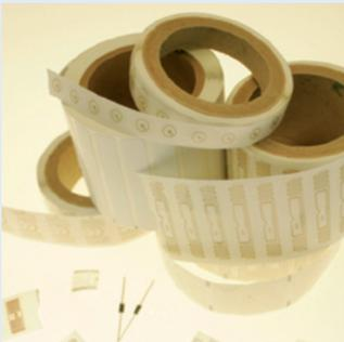
Die Datenträger (Transponder) bestehen aus einem Mikrochip (IC= Integrierter Schaltkreis) und einer Antenne. Über die Antenne wird der Mikrochip mit Energie aus dem (elektro-)magnetischen Feld der Antenne des Schreib-/Lesegeräts versorgt.
