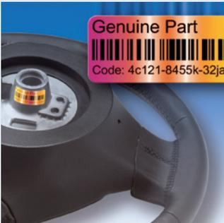
Optisch erkennbare Nanotechnikmerkmale: Hochglänzende Folie mit Nano-Cluster-Schichten, die Farbkippeffekt erzeugen. Diese Clusterschichten werden aufgedampft oder mit Hilfe des Sputter-Verfahrens aufgebracht.
