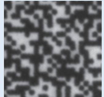
Feststellen und Ausnutzen von Schwankungen im Druckbild, die ein nicht reproduzierbares Zufallsmuster erzeugen. Das entsprechende Merkmal wird in einer Datenbank festgehalten oder in einem 2D-Barcode gespeichert.
