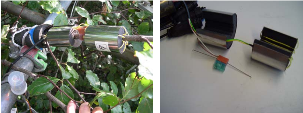
Abbildung 2.10: Xylemflusssensor nach Cermak/Kucera (EMS, Brno, CZ). Links im geschlossenen Zustand, am Ast montiert. Rechts im offenen Zustand (Nadeln und Heizspirale sichtbar).
