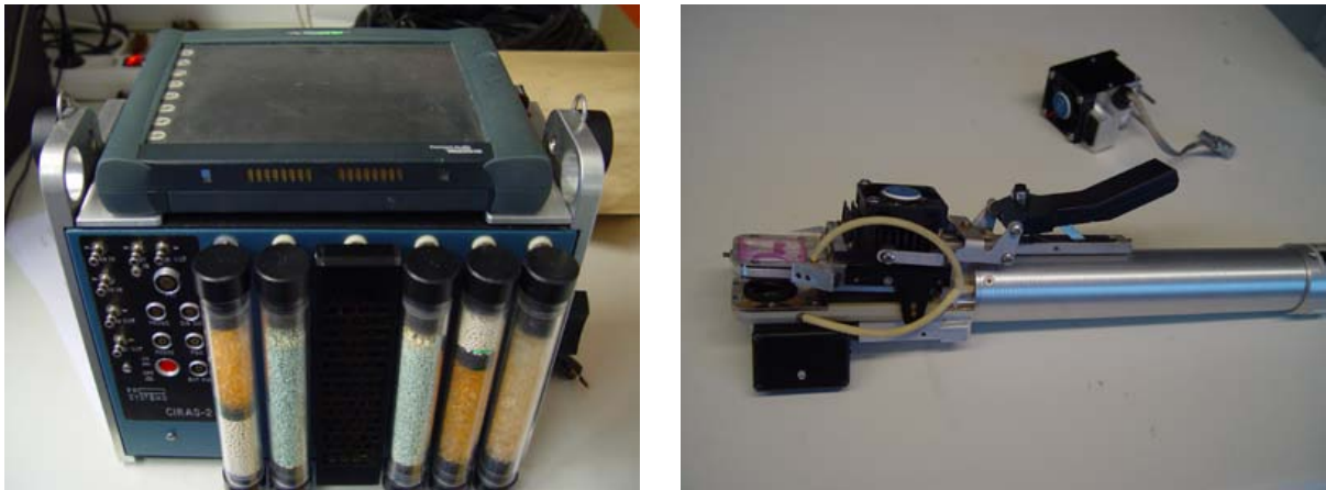
Abbildung 2.7: Links: Porometer CIRAS-2 der Firma PP Systems (Hitchin, UK), rechts: dazugehörige Gaswechsellkuvette (PP Systems, Hitchin, UK) für Laubgehölze.
