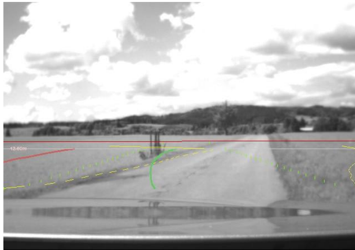
Abbildung 6.18: Das Bild 181 der Kurvenszene zeigt die Auswirkungen der Abweichung der Verlaufshypothese auf die Fahrbahnhypothese.
