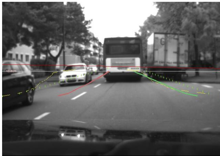
Abbildung 5.28: Im Bild 337 ist die Situation zu sehen, welche zur maximalen Abweichung der Verlaufshypothese im Ortschaftsszenario führt.
