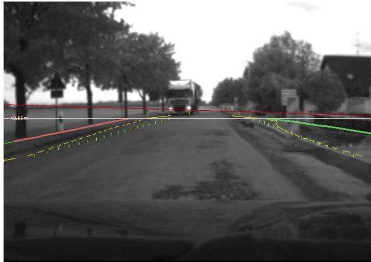
Abbildung 6.16: In Bild 1018 springt die rechte Hypothese auf den Fahrbahnrand hinter der Baustelle.
