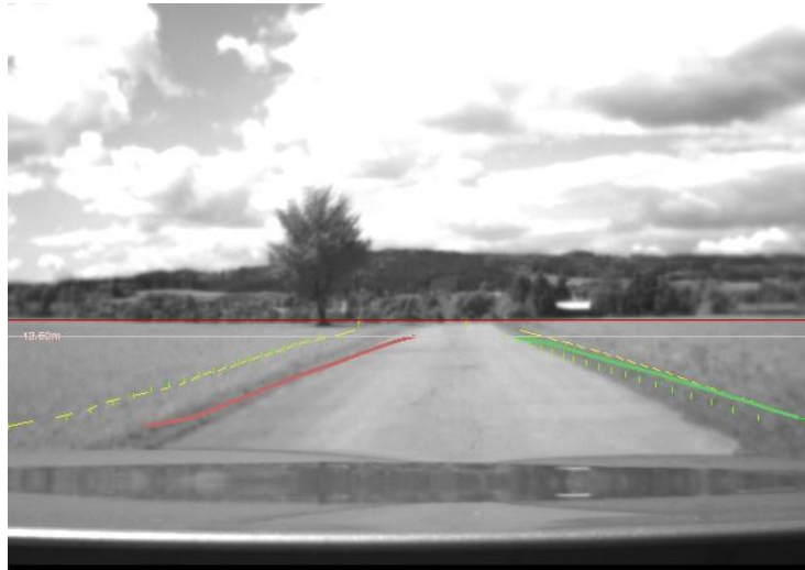
Abbildung 5.20: In Bild 224 ist die minimale Abweichung der Szene zum Test auf das Ansprechverhalten des Algorithmus zur Bestimmung des Fahrbahnverlaufes zu sehen.
