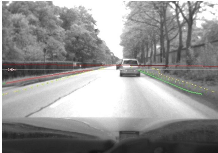
Abbildung 5.23: In Bild 270 ist ein Messfehler der rechten Verlaufsschätzung erkennbar. Verursacht wird dieser durch ein vorausfahrendes Fahrzeug.
