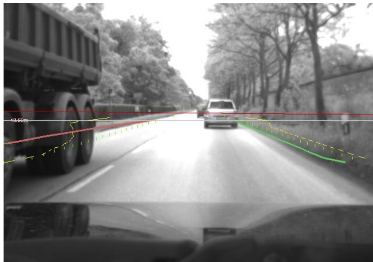
Abbildung 5.24: Das Bild 260 zeigt einen beidseitigen Messfehler. Zum Fehler, welcher durch das vorausfahrende Fahrzeug erzeugt wird, kommt der Fehler, welcher durch ein entgegenkommendes Fahrzeug verursacht wird, hinzu.
