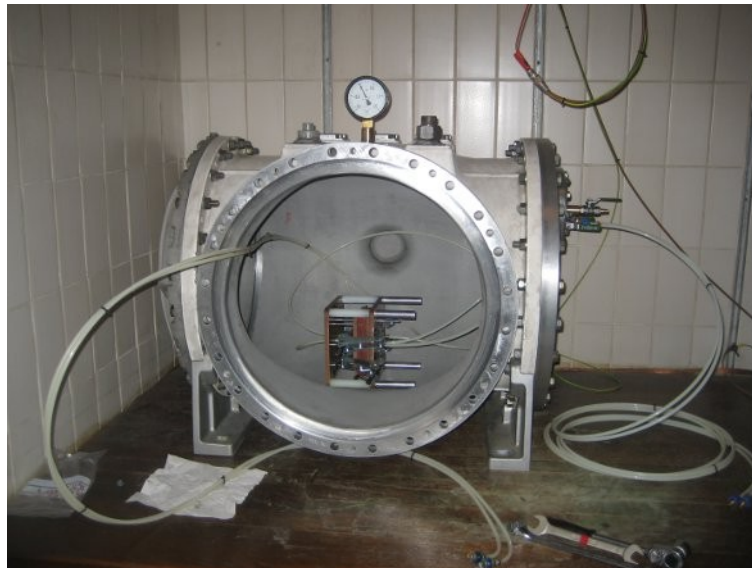
Abbildung 4.29: Versuchskessel für die Untersuchung von Mikrovaristormaterialien in unterschiedlichen Gasen
