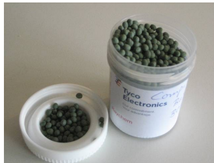
Abbildung 4.44: Mikrovaristorpellets; PE-Copolymer gefüllt mit Mikrovaristorpulver
