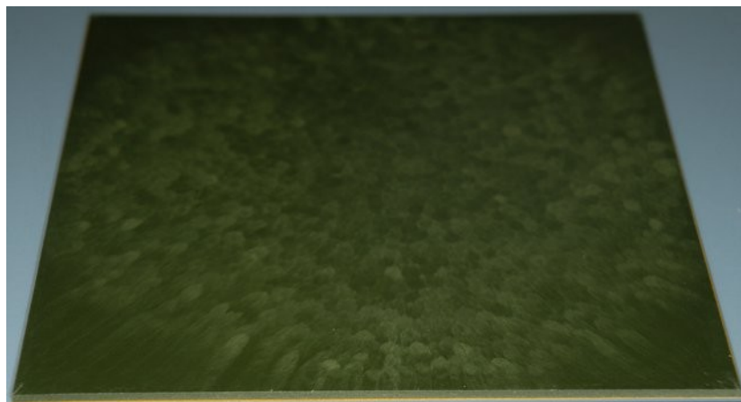
Abbildung 4.45: Plattenförmiger mikrovaristorgefüllter Polymerprüfling PE_Press, direkt aus Pellets gepresst
