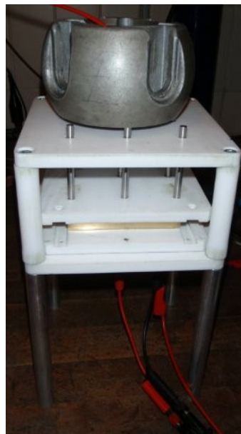
Abbildung 4.8: Prüfanordnung in horizontaler Ausrichtung zur Untersuchung von plattenförmigen Polymerprüflingen
