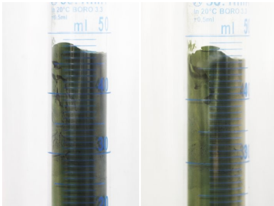
Abbildung 4.34: Mikrovaristorpulver in einem 50-ml-Messzylinder in einem transparenten Druckbehälter. Beide Aufnahmen zeigen Hohlräume im Pulver nach schnellem Evakuieren (circa 1 min).
