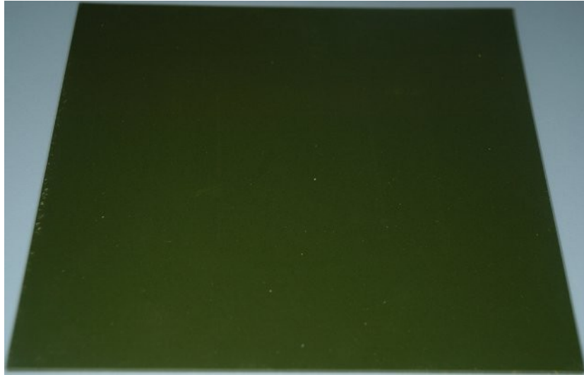
Abbildung 4.46: Plattenförmiger mikrovaristorgefüllter Polymerprüfling PE_Mix . Die Kunststoffpellets wurden vor dem Pressvorgang in einem Laborwalzenmischer durchgeknetet.
