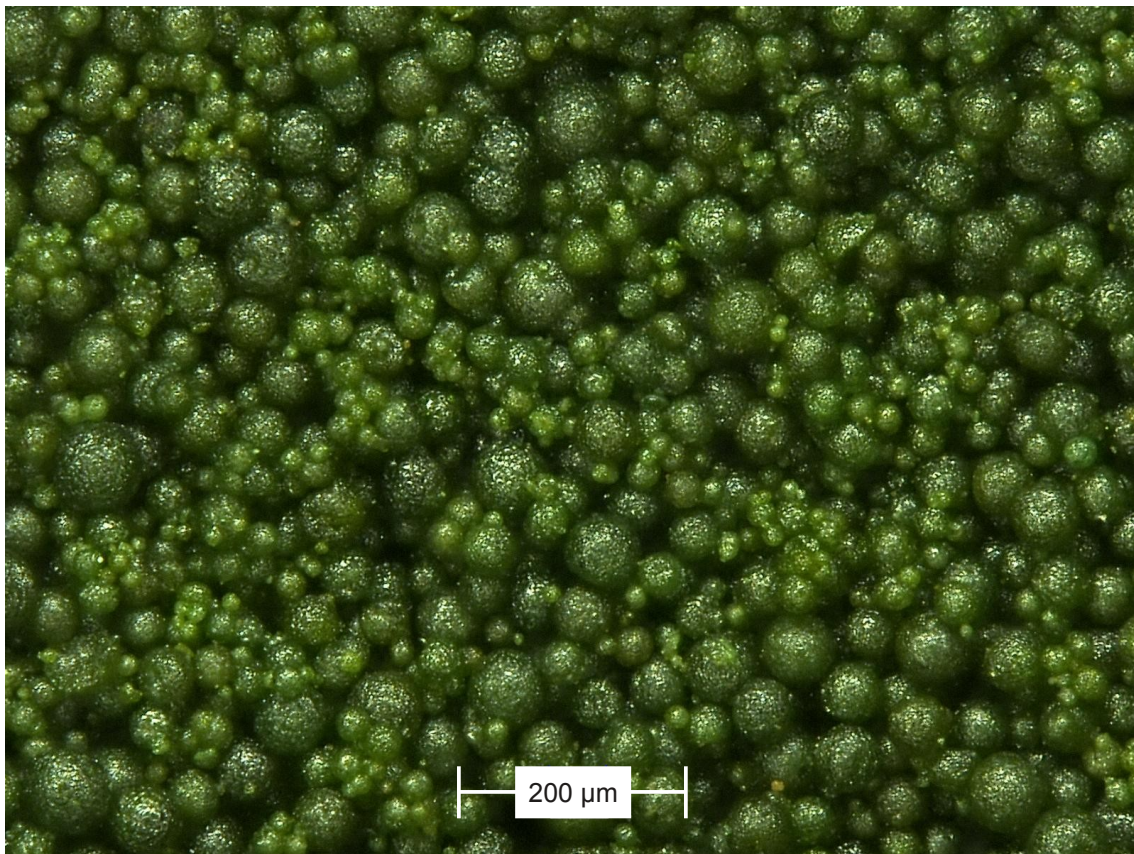
Abbildung 2.5: Mikroskopische Aufnahme von in dieser Arbeit untersuchtem Mikrovaristorpulver
