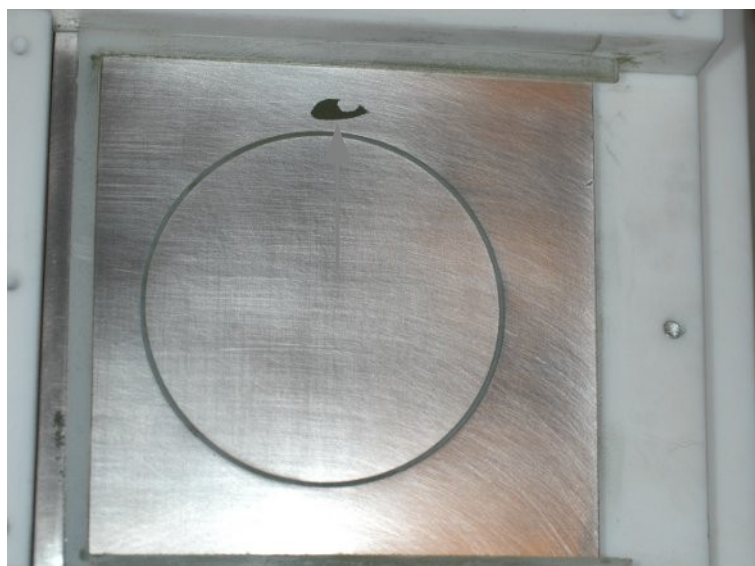
Abbildung 4.11: Pulveranhaftungen auf dem Schutzring der Aluminiumelektrode nach dem lokalen Versagen von Mikrovaristorpulver
