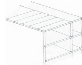
Tragende Mauerwände, große Spannbetondecke über Hauptraum
