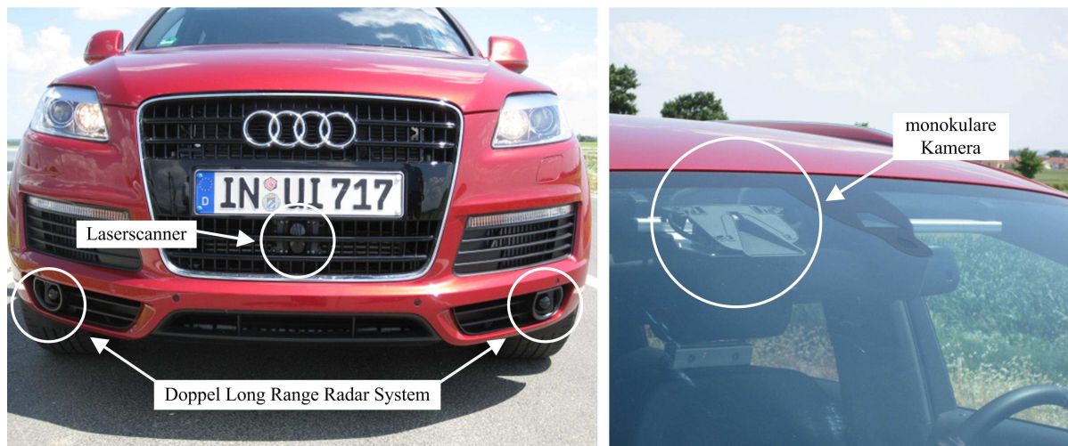
Bild 9.2: Umfellsensorik des Stauassistent-Versuchsträgers
