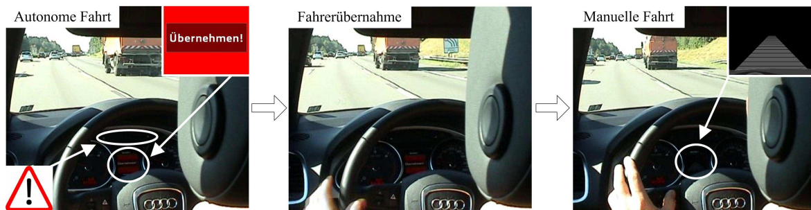
Bild 9.7: Fahrerübernahme bei einer Stauauflösung
