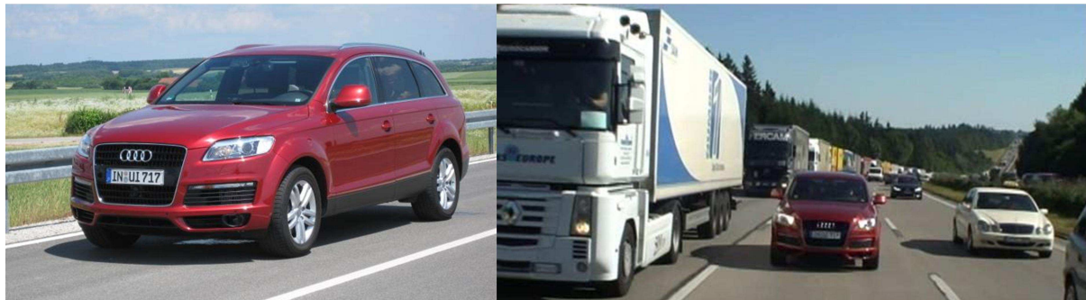
Bild 9.1: Versuchsträger am Testgelände (links) und im aktiven Stauassistent-Betrieb auf einer realen Autobahn (rechts)
