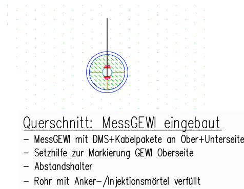
Abbildung 3: MessGEWI eingebaut im RS-Rohr
