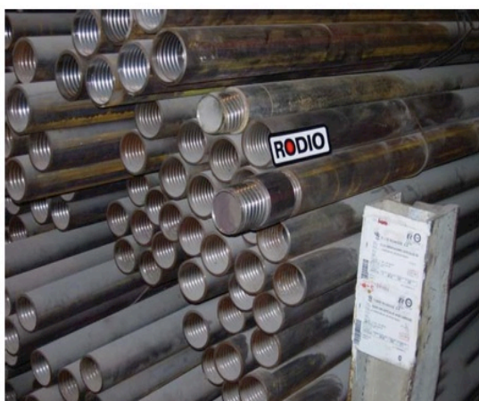
Abbildung 3.3: Rohrschirmrohre (s. SCHMIDT (2007), Fig. 3-9, S. 19)
