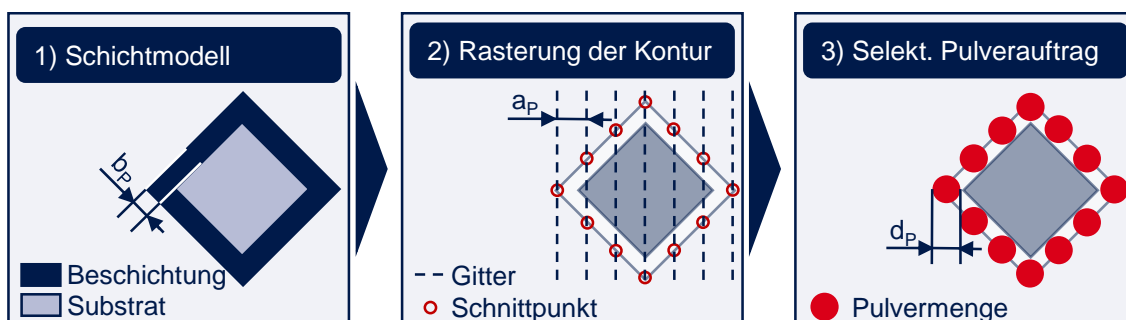
Abbildung 4-4: Datenverarbeitungskette vom Schichtmodell bis zum selektiven Pulverauftrag
