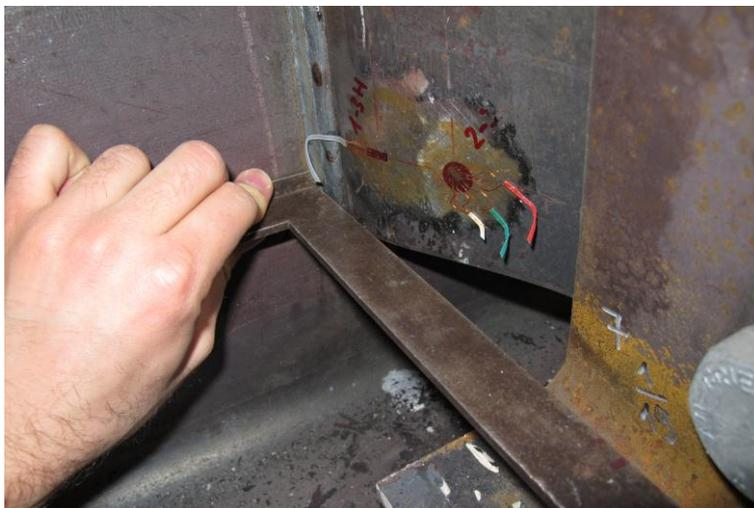
Abbildung 9-9: Plastisch verformtes Fahnenblech
