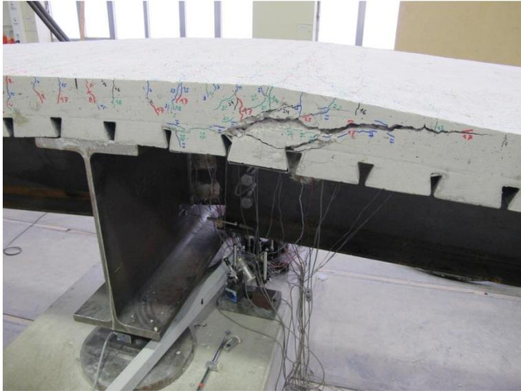
Abbildung 6-55: Schubriss im Betongurt (V2-3)
