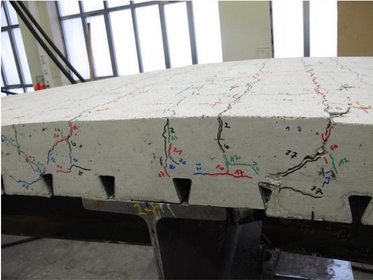
Abbildung 6-18: Schubriss im Betongurt (V2-1)
