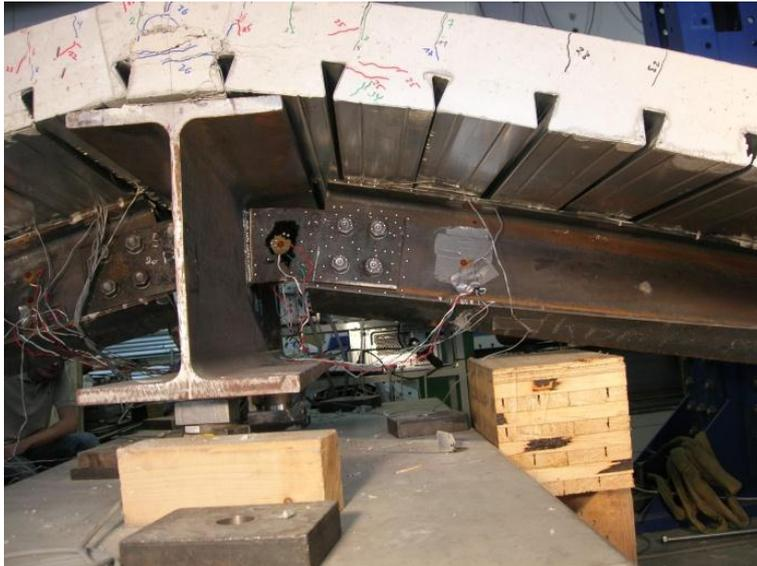
Abbildung 6-8: Stark plastisch verformter Anschlussbereich (V1-2)
