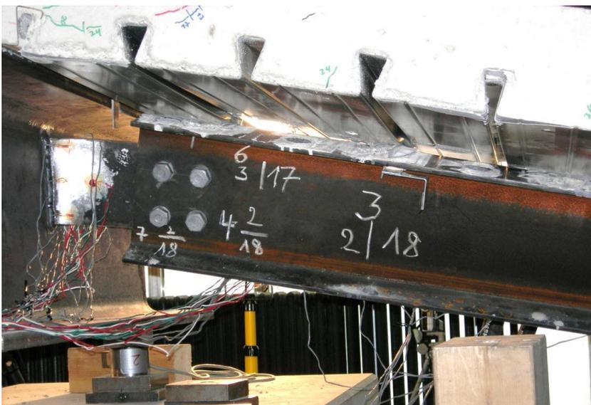
Abbildung 6-11: Durch Lateralverformung des Fahnenblechs initiiertes Biegedrillknicken des Sekundärträgers (V1-2)
