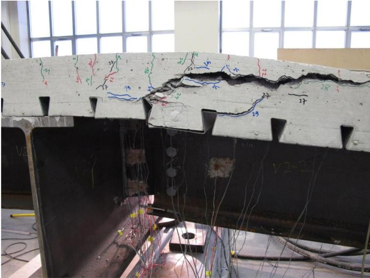
Abbildung 6-20: Abspalten des oberen Betongurteils durch fortschreitenden Schubriss (V2-2)
