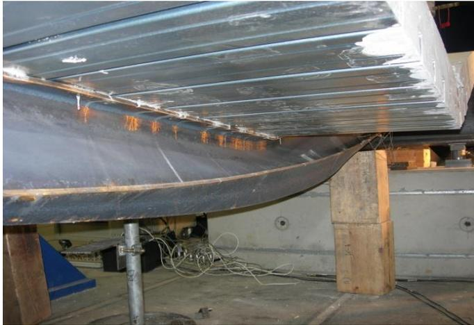
Abbildung 6-12: Verdrillter Sekundärträger (V1-2)
