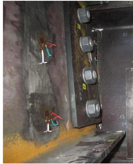
Abbildung 9-13: Stirnfläche des verformten Fahnenblechs
