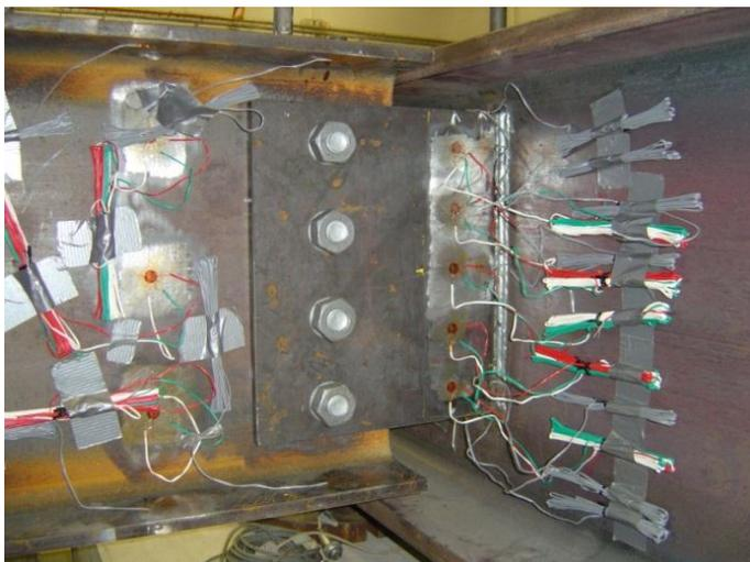
Abbildung 5-29: DMS und Rosetten auf Fahnenblech und Träger, Versuchsreihe 2
