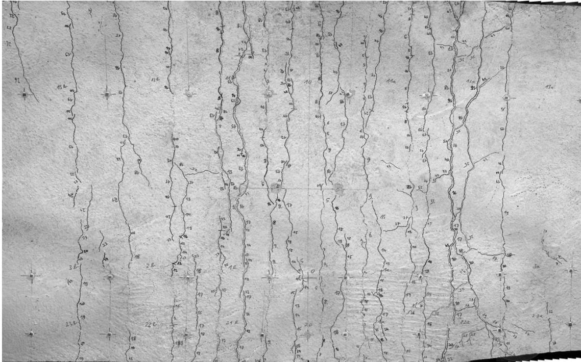
Abbildung 6-83: Rissbild des Betongurtes (V2-3)
