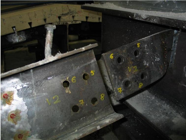
Abbildung 11-2: Schraubenlöcher ohne Ovalisierung, V1-2
