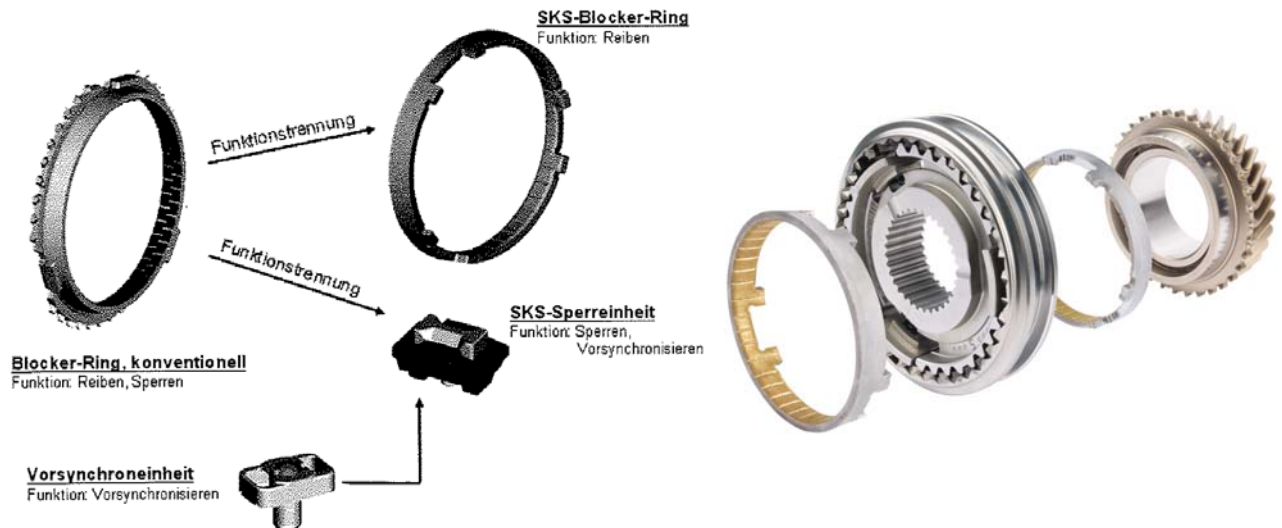
Bild 3-77: links: Vergleich konventionelle Bauart und Sperrkeil-Synchronisierung (SKS) [B1], rechts: Explosionsdarstellung [Quelle: Hoerbiger]
