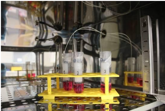
Abb. 9 Versuchsaufbau mit drei PU-Konstrukten zur Sauerstoffmessung
