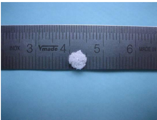
Abb. 3 Polyurethankonstrukt, 5mm Durchmesser
