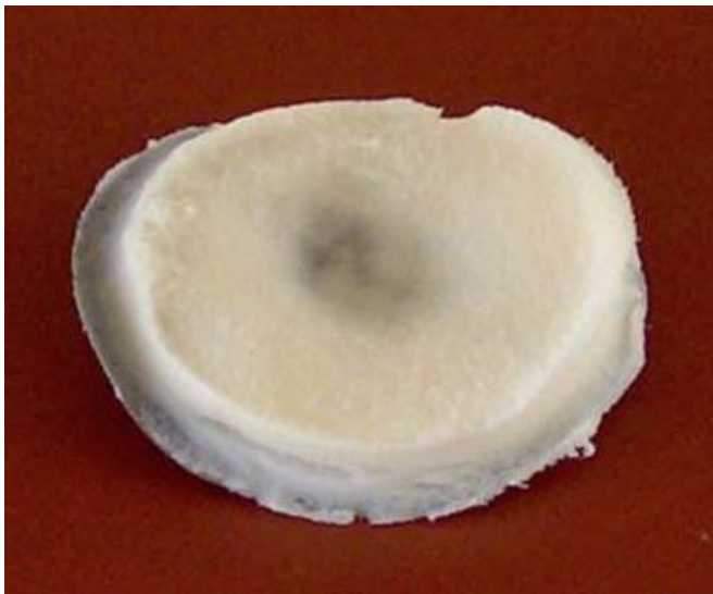
Abb. 4.17: Photographie eines Raiblefilterkuchens aus Zellulosefasern mit „Loch“
