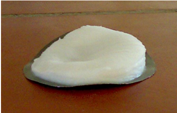
Abb. 4.28: 0,5 bar: Photographie eines ungleichmäßigen Raibleiterkuchens
