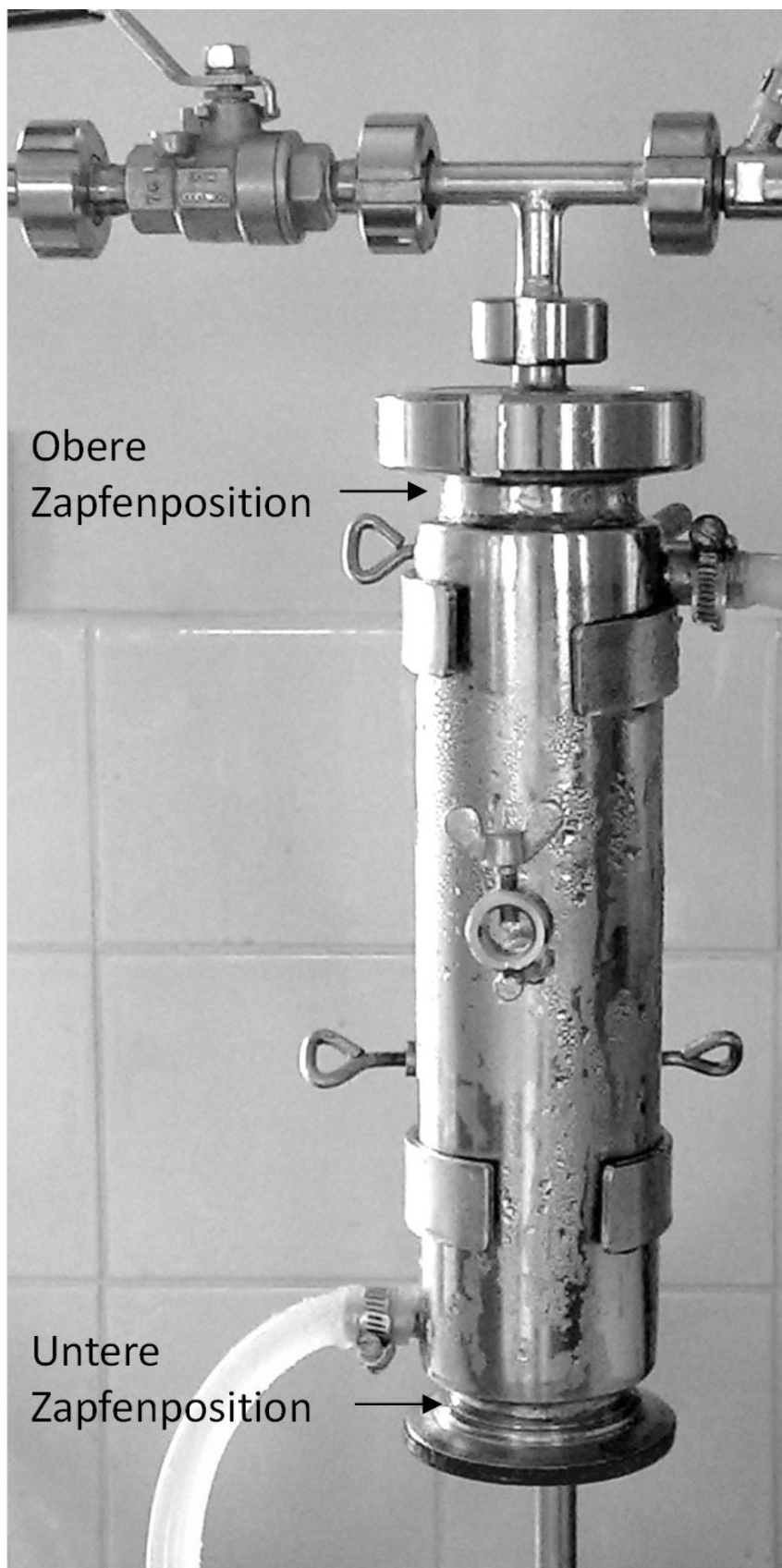
Abb. E.1: Photographie des Raible-Filtrationszylinders mit Kennzeichnung der erprobten Zapfenpositionen
