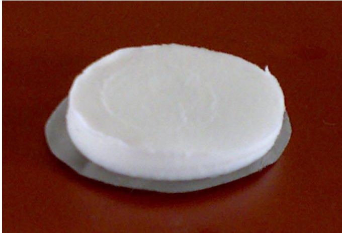
Abb. 4.30: 0,7 bar: Photographie eines Raible-Filterkuchens Scheibe mittel, erhöhte Einwaage 1,48 g / 0,90 g
