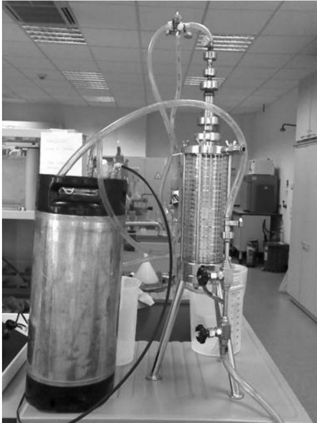
Abb. E.2: Photographie des EBC-Filters zur Permeabilitätsbestimmung nach DARCY
