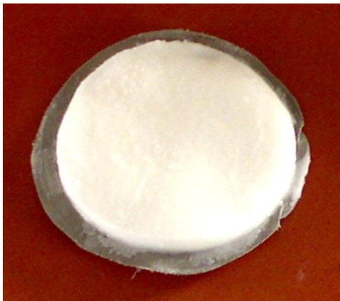
Abb. 4.25: Photographie eines über Dralleinsatz angeschwemmten Raiblefilterkuchens als Beispiel Scheibe mittel, normale Einwaage 0,98 g / 0,40 g, Überdruck 1,0 bar
