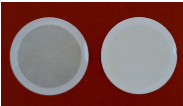
Abb. 4.15: Vergleich der Einlagen nach Membranfiltration von Filtraten des Angepaßten Raible-Tests mit bzw. ohne RHA
