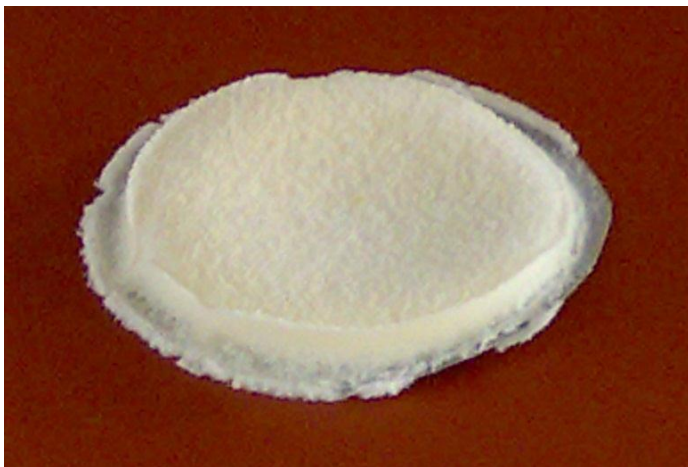
Abb. 4.19: Vollfüllen des Zylinders: Photographie eines Raiblefilterkuchens aus Zellulosefasern
