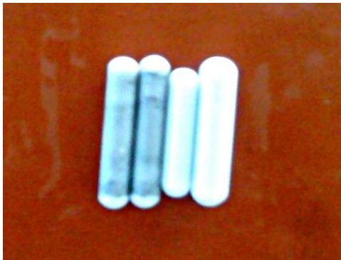
Abb. 4.14: Photographie der Ablagerung auf Rührfischchen nach der Regeneration von RHA
