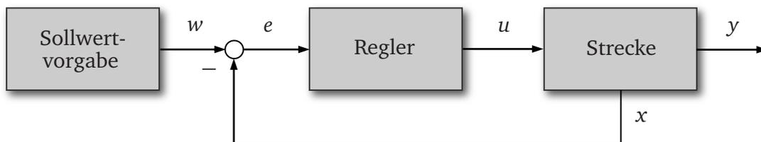
**Bild 2.5:** Struktur einer Regelung
