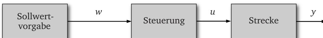
**Bild 2.4:** Struktur einer Steuerung
