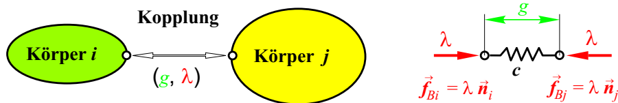
Bild 60: Kopplung zweier Körper im MKS am Beispiel einer Feder
