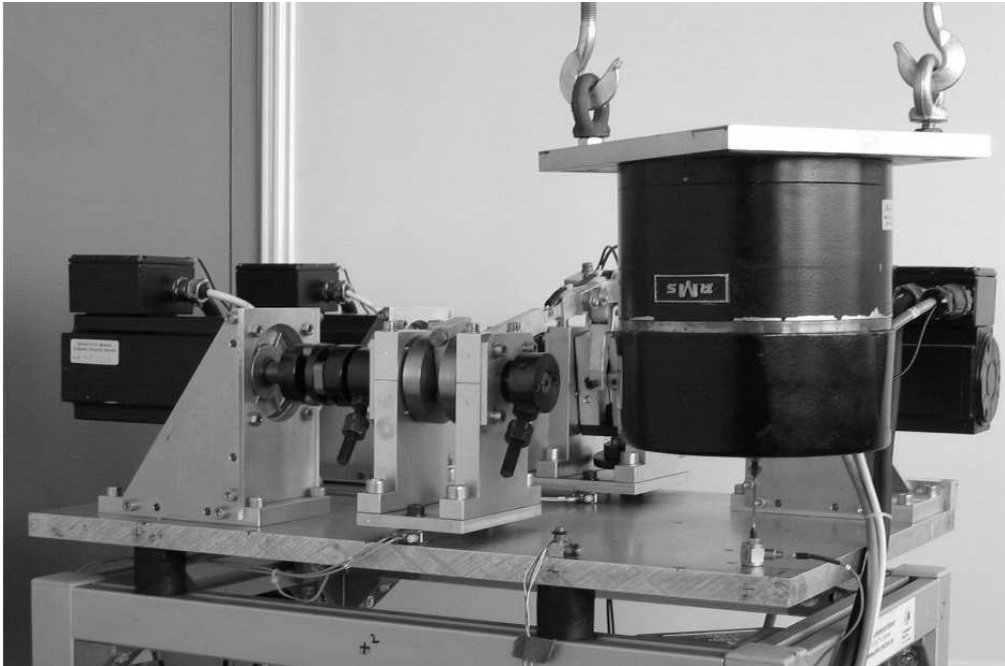
Bild 95: Messaufbau zur Modalanalyse mit Shaker
