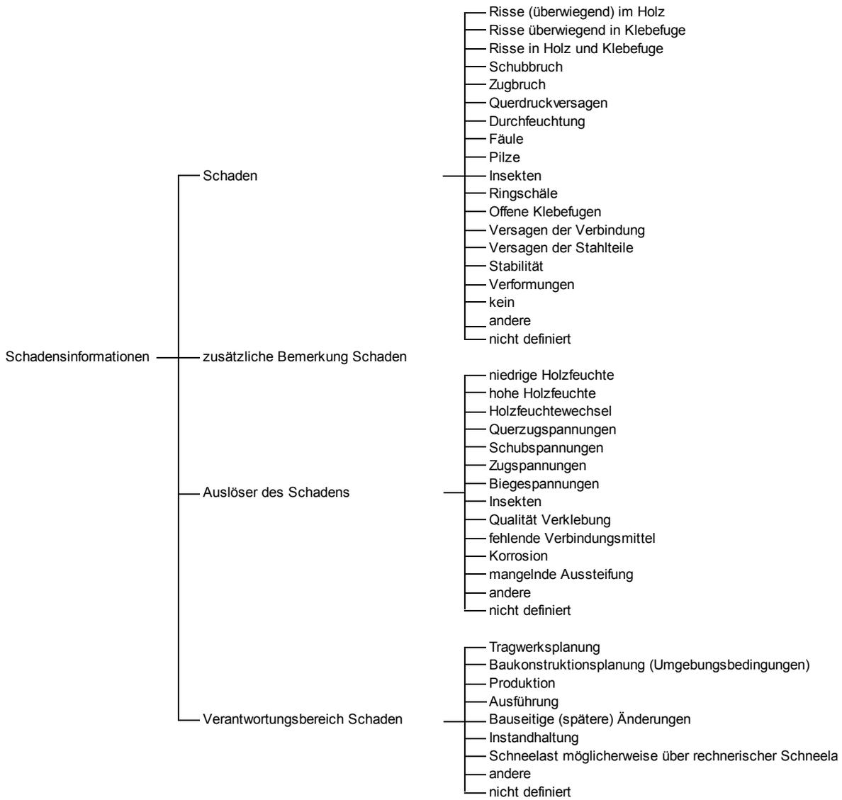
Abbildung A4: Baumdiagramm (in Anlehnung an [Blaß & Frese 2010]) zur Darstellung der Schadensinformationen und zugehörige Schlagwörter – Teil 1
