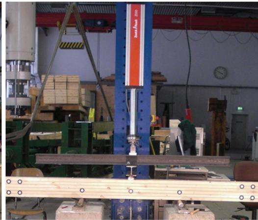
Abbildung 81: Versuchsaufbau zur Messung des scheinbaren Elastizitätsmoduls
