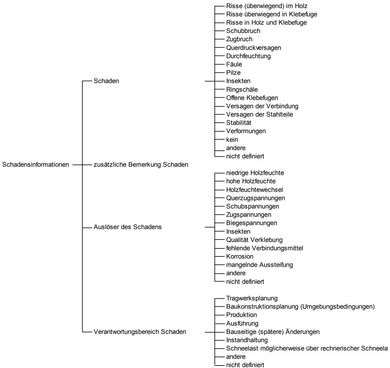
Abbildung 1: Baumdiagramm (in Anlehnung an [Blaß & Frese 2010]) zur Darstellung der Schadensinformationen und Schlagwörter
