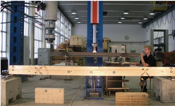
Abbildung 80: Versuchsaufbau zur Messung des globalen und lokalen Elastizitätsmoduls
