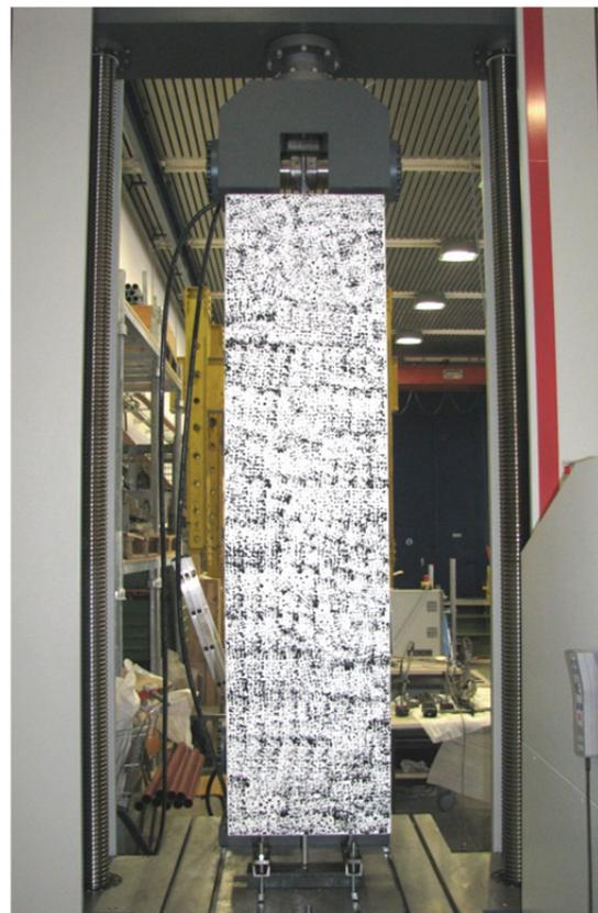
Abbildung 176: Prüfkörper 1.1 in Prüfmaschine, incl. stochastisches s/w-Muster
