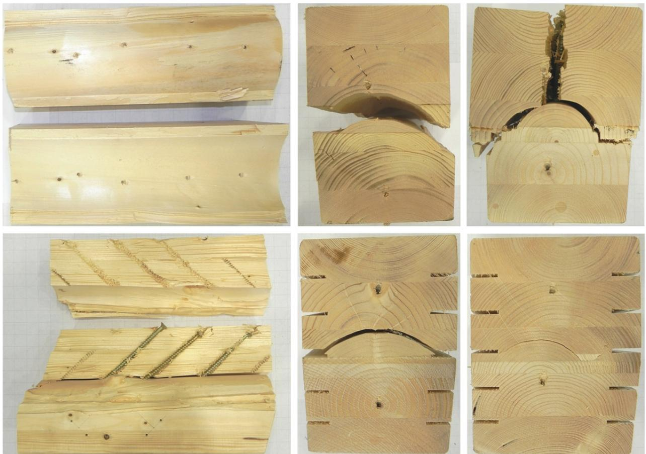
Abbildung 88: Typische Brucharten der Scherprüfkörper nach [Besenius 2010]
