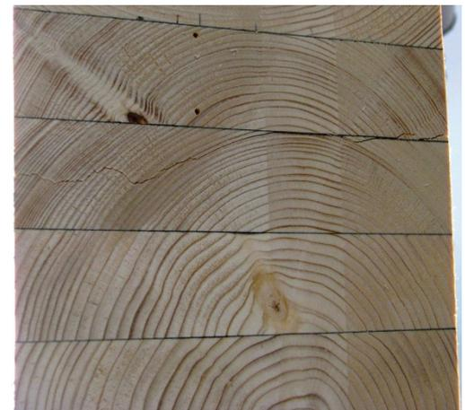
Abbildung 180: Hirnholzfläche eines gerissenen Prüfkörpers und typische Jahrringlage
