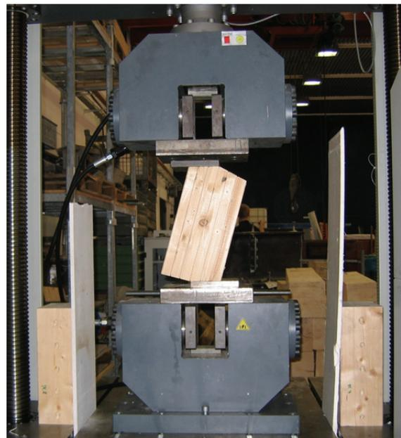
Abbildung 86: Versuchsaufbau und Prüfkörpergeometrie für die Scherversuche
