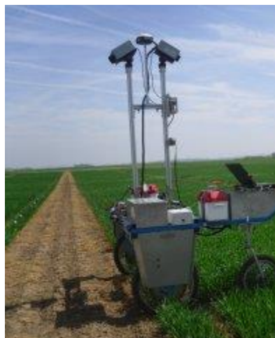
Abb. 7: Aktiver N-Sensor ® ALS der Fa. Yara auf Fahrgestell montiert
