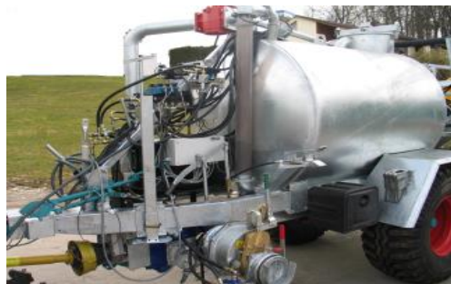
Abb. 4: Versuchsfass zur Ausbringung der flüssigen Wirtschaftsdünger im Feldversuchswesen
