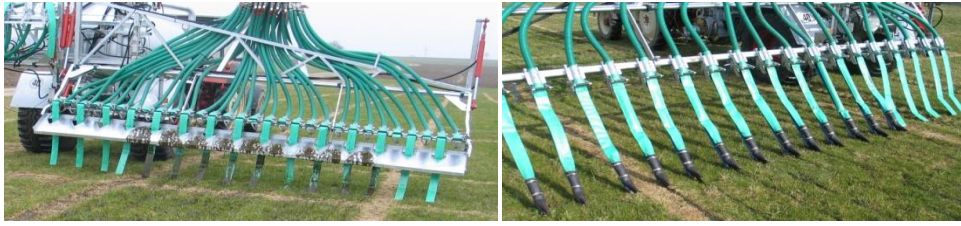
Abb. 2: Breitverteiler-, Schleppschlauch- und Schleppschuhtechnik am Versuchsfass
