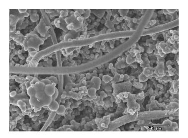
**Abbildung 3.13:** REM-Aufnahme der Oberseite einer monolithischen Säule mit POM-Ablösungen, 500-fache Vergrößerung (Messung: Christine Sternkopf, IWC).
