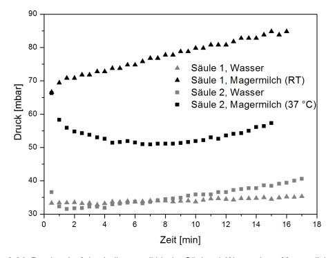
Abbildung 3.24: Druckverlauf durch die monolithische Säule mit Wasser bzw. Magermilch.
