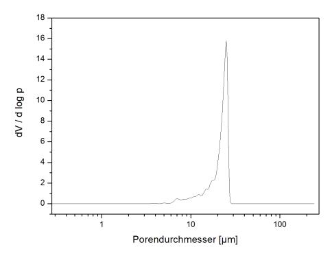
**Abbildung 3.3:** Bestimmung des mittleren Porendurchmessers der monolithischen Säule mittels Hg-Porosimetrie (Messung: Xaver Hecht, TUM).
