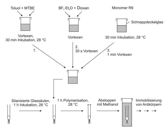
**Abbildung 5.2:** Herstellung der monolithischen Säule durch Polymerisation des Epoxy-Polymers in den Glaskörper.
