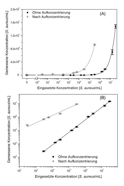
**Abbildung 3.20:** (A) Kalibrierkurven für *S. aureus*: ohne Aufkonzentrierung: m = 3, n = 12,  $R^2 = 0.9751$ ; nach Aufkonzentrierung: m = 3, n = 8,  $R^2 = 0.9854$ ; (B) linearer Bereich: ohne Aufkonzentrierung: m = 3, n = 9,  $R^2 = 0.9928$ ; nach Aufkonzentrierung: m = 3, n = 5,  $R^2 = 0.9998$ .
