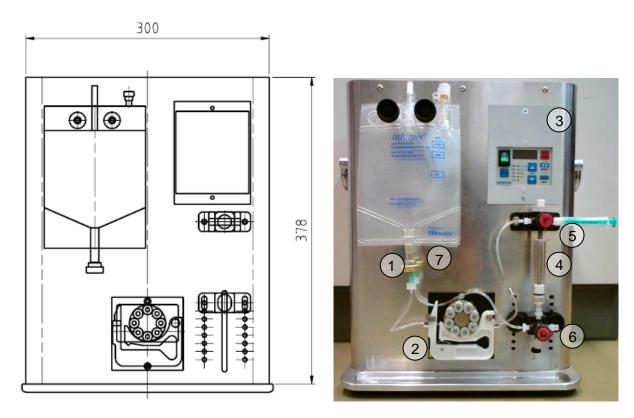
**Abbildung 3.17:** Aufkonzentrierungsapparatur: Konstruktionszeichnung (links), Aufbau (rechts): (1) Sterilbeutel mit Probe, (2) Peristaltikpumpe, (3) Steuerungselement, (4) monolithische Affinitätssäule mit PTFE-Fitting, (5) Spritze zur Vorwärtselution, (6) Auslass zum Auffangen des Eluats (vorwärts), (7) Sterilbeutel mit Durchlauf.
