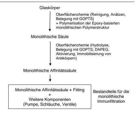
**Abbildung 3.1:** Herstellung und Bezeichnung der einzelnen Komponenten einer monolithischen Immunfiltration.
