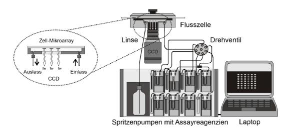
Abbildung 5.3: Schema des Mikroarray-Auslesegeräts Immunomat [269].
