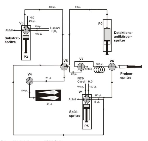
Abbildung 5.6: Fluidikplan des MCR3 SLT.
