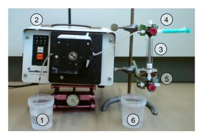
**Abbildung 3.16:** Erster Aufkonzentrierungsaufbau: (1) Sterilbecher mit Probe, (2) Peristaltikpumpe, (3) monolithische Affinitätssäule mit PTFE-Fitting, (4) Spritze zur Vorwärtselution, (5) Auslass zum Auffangen des Eluats (vorwärts), (6) Sterilbecher mit Durchlauf.
