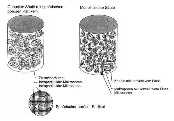
**Abbildung 2.21:** Querschnitt durch eine gepackte Säule mit sphärischen porösen Partikeln und durch eine monolithische Säule [225] (modifiziert).
