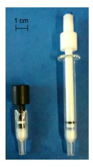
Abbildung 3.12: POM-Fitting (links), PTFE-Fitting (rechts).
