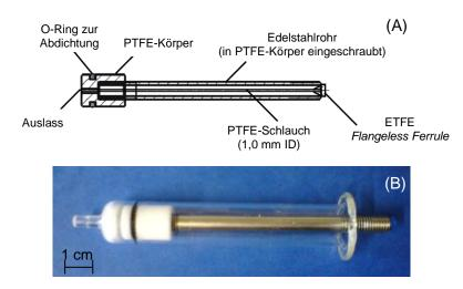
**Abbildung 3.14:** (A) Konstruktionszeichnung des PTFE-Fittings, (B) PTFE-Fitting verbunden mit einer monolithischen Säule.
