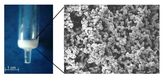
**Abbildung 3.2:** Monolithische Säule (links), REM-Aufnahme einer monolithischen Säule mit 500-facher Vergrößerung (rechts; Messung: Christine Sternkopf, IWC).
