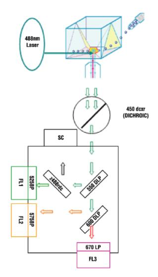
**Abbildung 2.10:** Schematischer Aufbau des Durchflusszytometers *Cell Lab Quanta™ SC* von Beckman Coulter mit Laseranregung [99] (modifiziert): dichroitischer Spiegel (450 dcxr (DICHROIC)), Streulicht (SC), Fluoreszenzdetektoren (FL1-FL3), Dichroitischer *Longpass*-Filter (DLP), Laser-Strahlteiler (z488rdc) *Longpass*-Filter (LP), *Bandpass*-Filter (BP).
