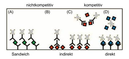
**Abbildung 2.4:** Testformate: (A) Sandwich-Immunoassay, (B) indirekt nichtkompetitiver Immunoassay, (C) indirekt kompetitiver Immunoassay, (D) direkt kompetitiver Immunoassay [72] (modifiziert).
