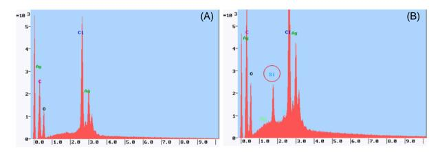
**Abbildung 3.5:** EDX-Aufnahmen einer Negativkontrolle (A) und einer Säule mit GOPTS (B) zum Nachweis des Siliziums von GOPTS (Messung: Christine Sternkopf, IWC).
