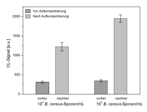
**Abbildung 3.44:** Nachweis mit Antikörper-Mikroarrays: CL-Signale vor und nach der Aufkonzentrierung von *B. cereus-Sporen* in 100 mL Magermilch (m = 5).
