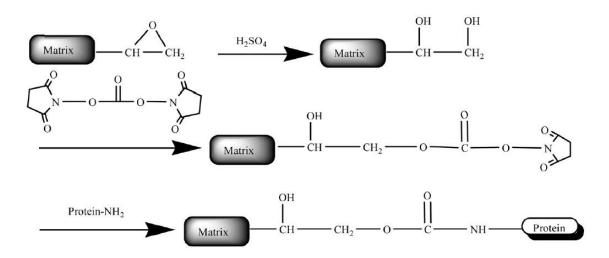
Abbildung 2.17: Disuccinimidylcarbonat (DSC)-Methode [146].
