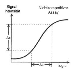
**Abbildung 2.8**: Sigmoidaler Kurvenverlauf eines Sandwich-Immunossays bzw. nichtkompetitiven Immunoassays [76].
