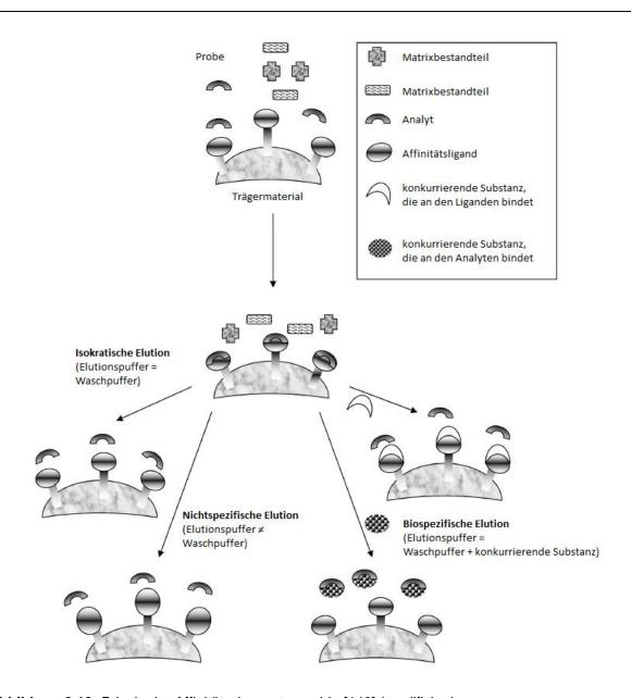
**Abbildung 2.12:** Prinzip der Affinitätschromatographie [146] (modifiziert).
