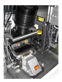
**Abbildung 5.8:** Flusszelle des MCR3 SLT: links: geschlossene Flusszelle, rechts: geöffnete Flusszelle durch entriegelte CCD-Kamera.
