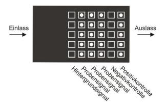
**Abbildung 5.9:** Schematische Abbildung des Mikroarray-Chips und des Rasters der Auswertesoftware *MCRImageAnalyzer*.
