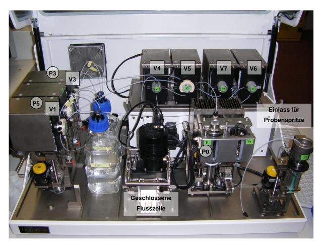
**Abbildung 5.7:** Aufbau des MCR3 SLT: Einlass für Probenspritze, (P0) Detektionsantikörper-Spritze, (P3) Substratspritze, (P5) Spülspritze, (V1, V3, V5) Sechsfach-Ventile, (V6, V7) T-Ventile, (V4) Ventil zu den Flusszellen, geschlossene Flusszelle.
