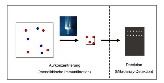
**Abbildung 1.1:** Schema der Kombination aus Aufkonzentrierung und Detektion.
