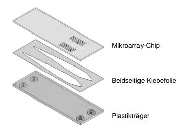
**Abbildung 5.5:** Schematische Abbildung des Mikroarray-Chips für die MCR3 SLT-Messung [73] (modifiziert).
