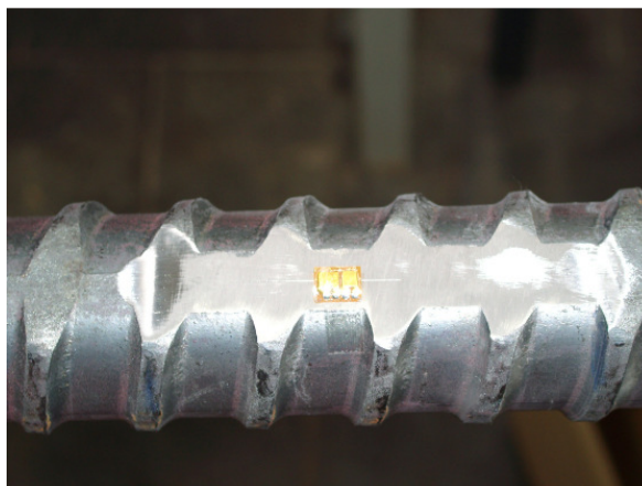
Abbildung 4.17: DMS auf GEWI-Stahl
