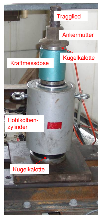
Abbildung 4.11: Detail Lastaufbringung und Kraftmessung
