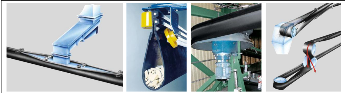
Abbildung 11: Funktionsprinzip Schlauchtaschengurtförderer [Gün-2008]
