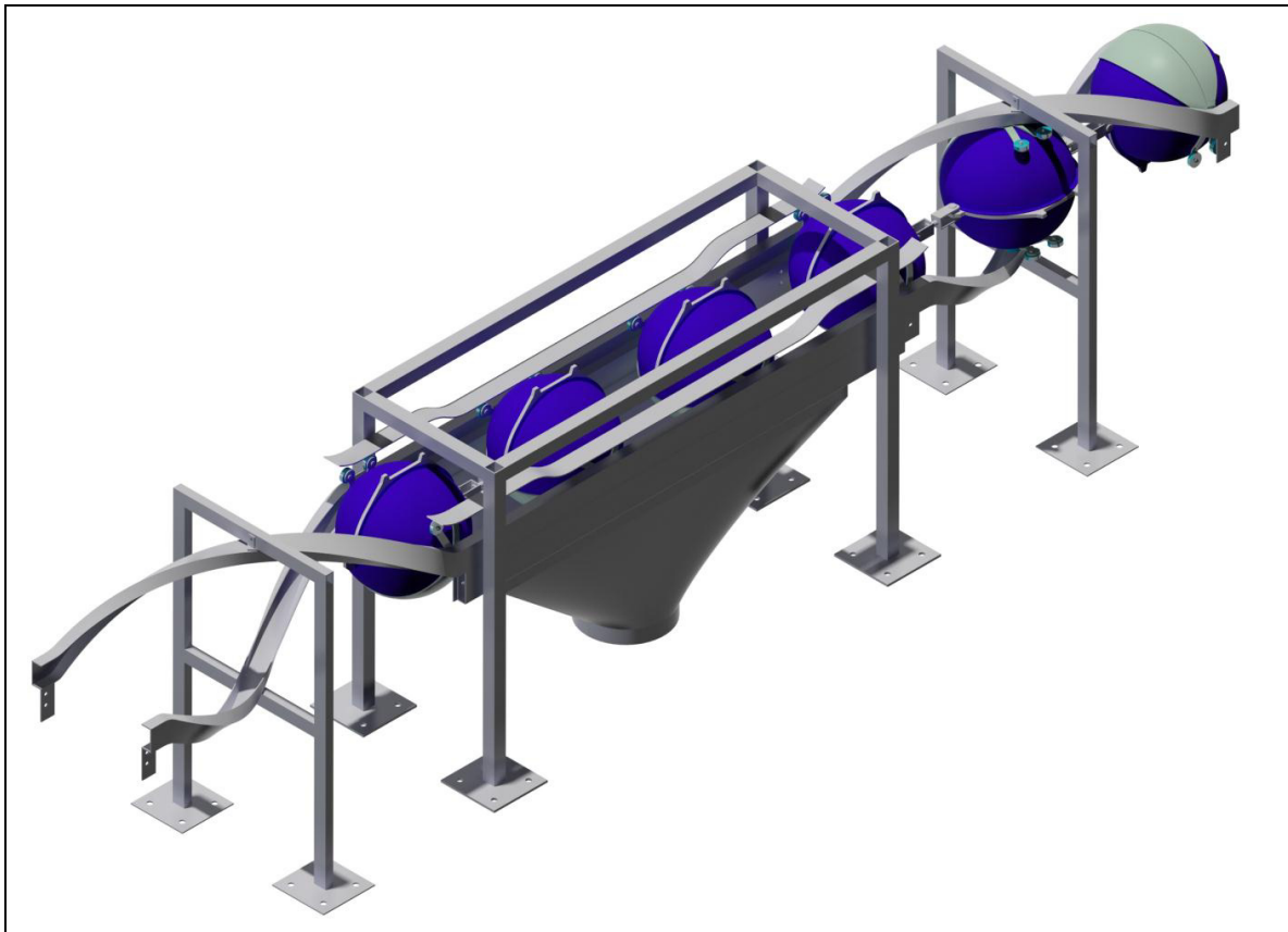
Abbildung 87: Abgabestation zur Entladung der Kugelbehälter
