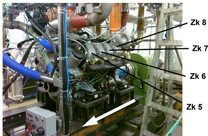
Bild 52: Nummerierung der Zylinder im Motorenversuch
