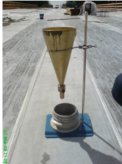
Abbildung 4.3: links: Trichter für die Prüfung des Fließvermögens (Maße in mm) [2]; rechts: Trichter auf der Baustelle, [Bilder 2007, F. Al Atiki]
