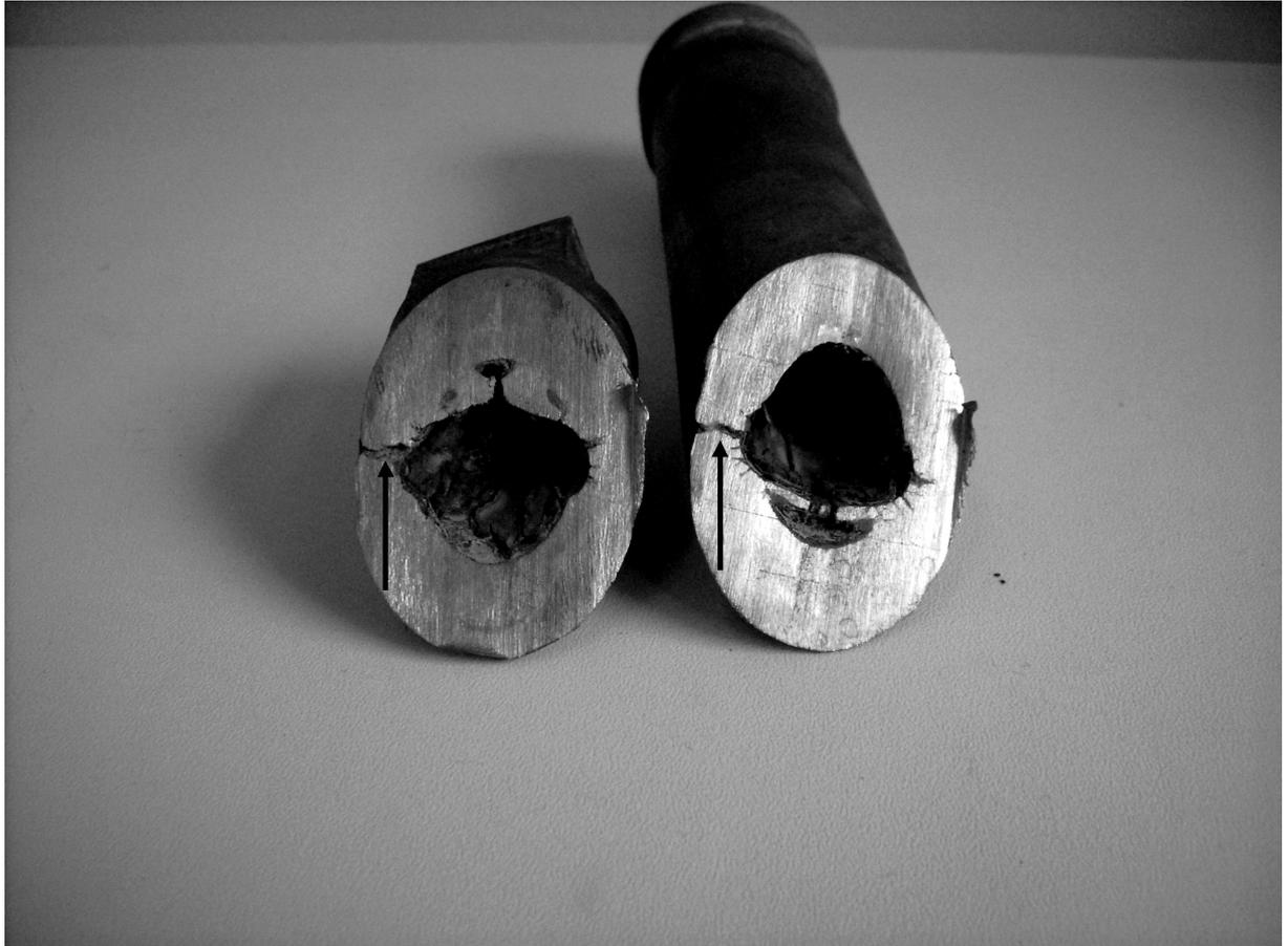
Abbildung 8: Bei einer Umsetzung mit Fluor undicht gewordener Autoklav. An der Stelle des Lecks wurde das Autoklaven-Unterteil zersägt, um das Leck sichtbar zu machen (Pfeile).
