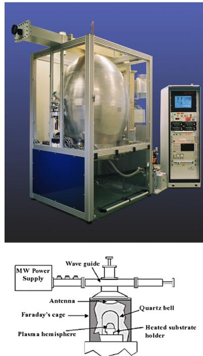
Abbildung 21: Oben: MPACVD - Reaktor am Fraunhofer - Institut für Angewandte Festkörperphysik. Abbildung aus[81]. Unten: Schematischer Aufbau eines derartigen CVD - Reaktors. Abbildung aus[84]
