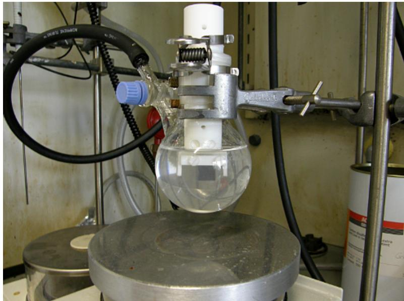
Abbildung 104: Apparatur zur Oberflächenmodifikation von SAMs, hier der Reduktion von 4-Cyanobiphenyl auf NCD. Es handelt sich um eine PTFE Klemmhalterung in welche die Proben eingespannt werden. Diese passt in Glasgeräte mit NS 29 Hülsen und schließt sie luftdicht ab, so dass auch unter Schutzgas gearbeitet werden kann.
