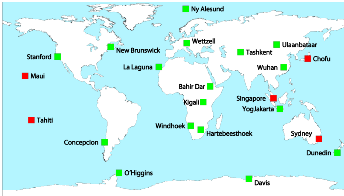
Abbildung 15: Tracking-Stationen des CONGO-Netzwerks. QZSS-fähige Stationen sind in rot dargestellt (Stand November 2011).
