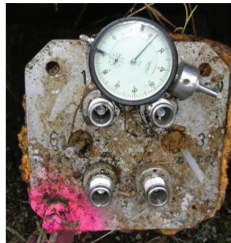
Abb. 6: Bohrkopf mit Mehrfach-Stangenextensometern und analoge Messuhr
