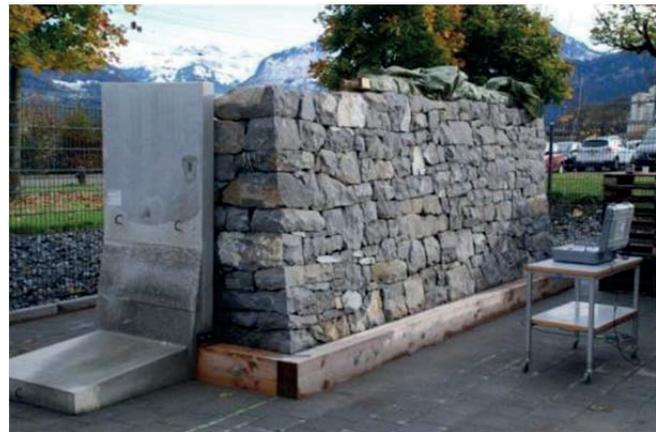
Abb. 5: Mauerwerksprobekörper an der Hochschule Luzern – Technik & Architektur.
