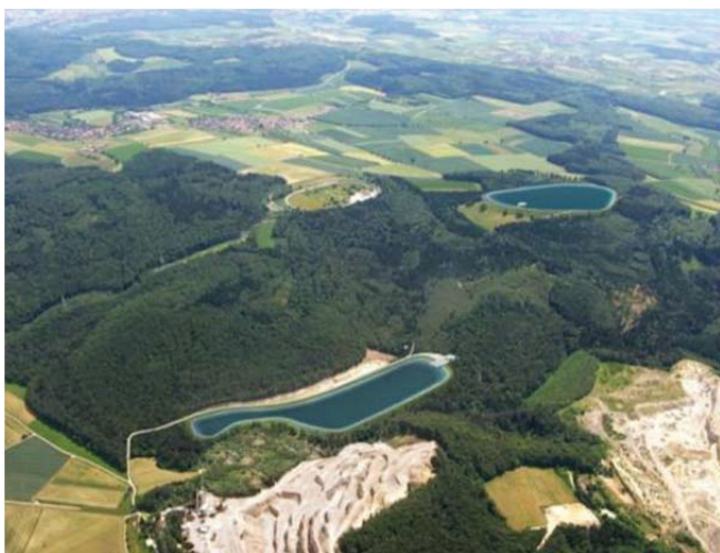
Abb. 1: Luftbild des geplanten Standortes des Pumpspeicher-werks (PSW) Blautal mit Montage des Ober- und Unterbeckens.
