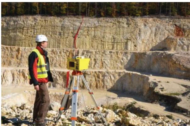
Abb. 3: IIRIS-Optech 3D-Scanner bei der Aufnahme der Ostwand des Pumpspeichers Blautal.
