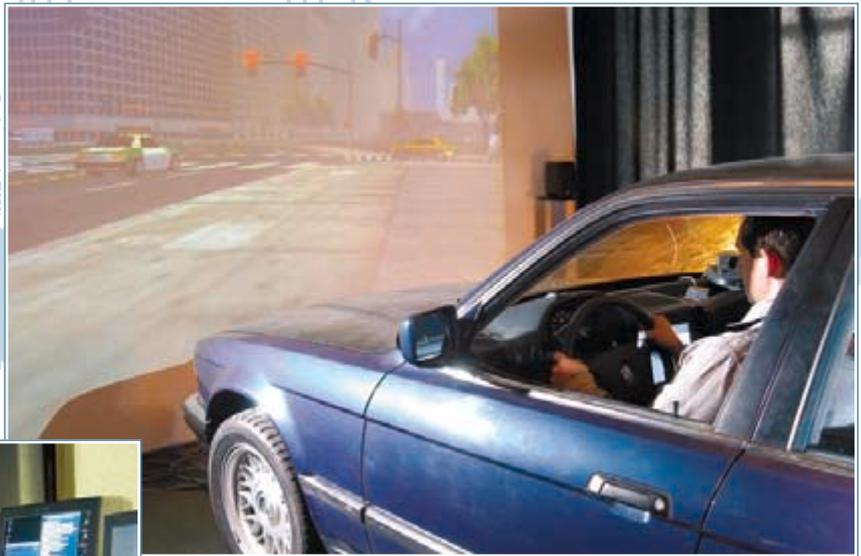
**FAHRSIMULATOR:** Unter der Haube des Autos in einem Usability-Lab der TU München arbeitet kein Motor, sondern ein älterer Pentium-PC, der die Simulation steuert (links oben). Im Kontrollraum (links) werden die Sprachbefehle des Testfahrers noch manuell umgesetzt – Vorarbeit für einen automatischen Dialog zwischen Fahrer und Fahrzeug.
