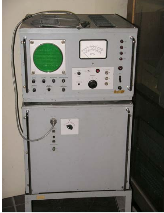
Bild 21: Ur-Lautheitsmesser in analoger LC-Technik
