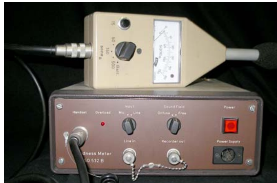
Bild 22: Tragbarer Lautheitsmesser in analoger RC-Technik
