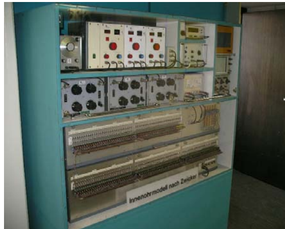
Bild 11: Zwickers elektronisches Innenohrmodell in analoger RC-Technik
