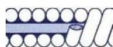
Abbildung 1: Schnitt durch eine unwickelte Gitarrensaitenstruktur. Der massive Kern ist schraubenförmig mit einem dünneren Draht umspinnen.
