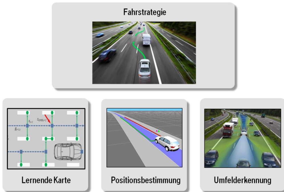
Abbildung 2: Kerntechnologien für das hochautomatisierte Fahren auf der Autobahn
