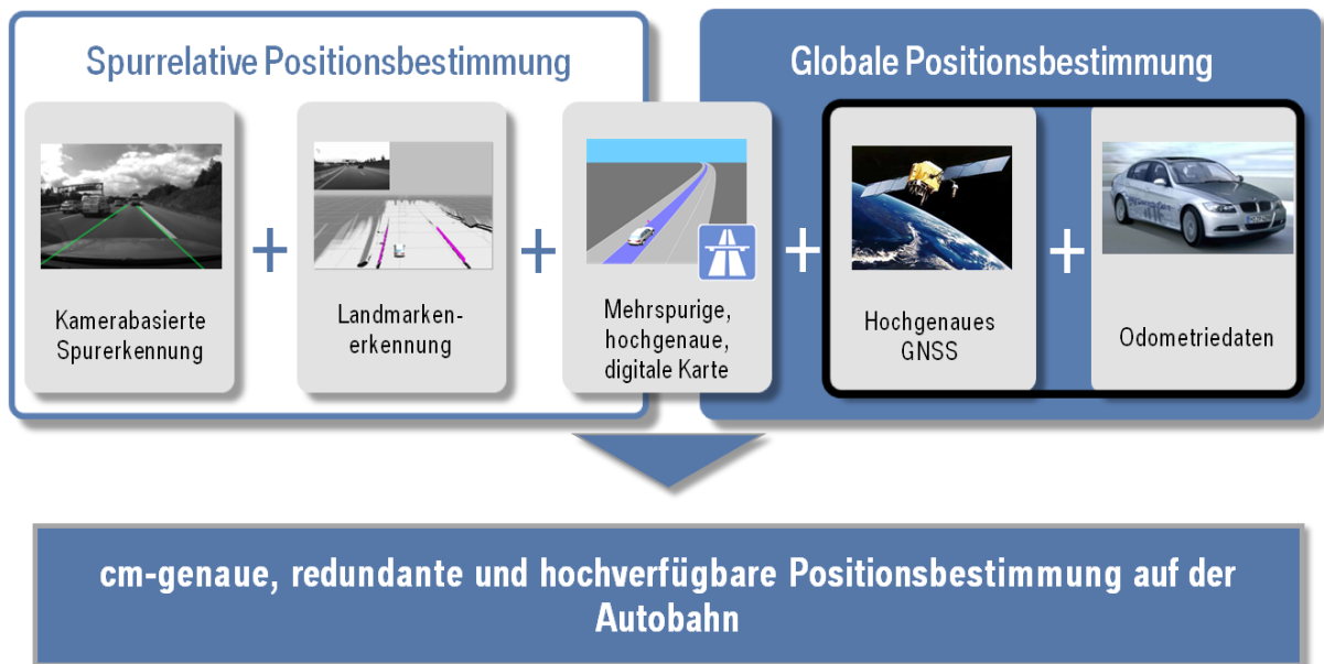
Abbildung 3: Hochgenaue Positionsbestimmung auf Autobahnen durch Sensorfusion
