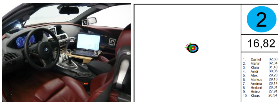
Abbildung 3-1: Darstellung der Nebenaufgabe. Links: Setup im Fahrzeug. Rechts: Zweidimensionaler Trackingtask als Nebenaufgabe
